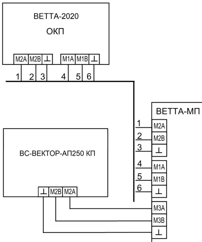
Рис. А3. Схема подключения КП прибора к ОКП ВЕТТА-2020 с использованием двух каналов связи RS-485
