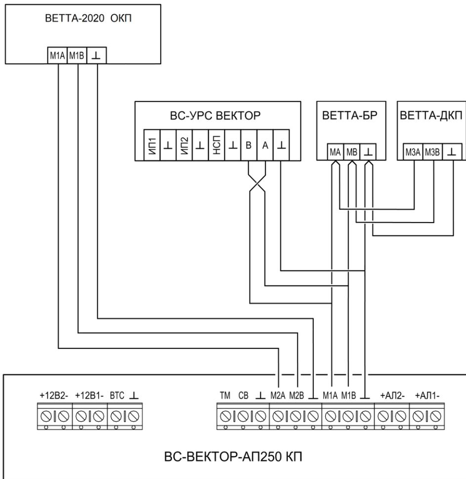
Рис. А2. Схема подключения дополнительных блоков к КП линиями связи RS-485, подключение КП к ВЕТТА-2020 ОКП ВЕТТА-2020 одним каналом связи RS-485
