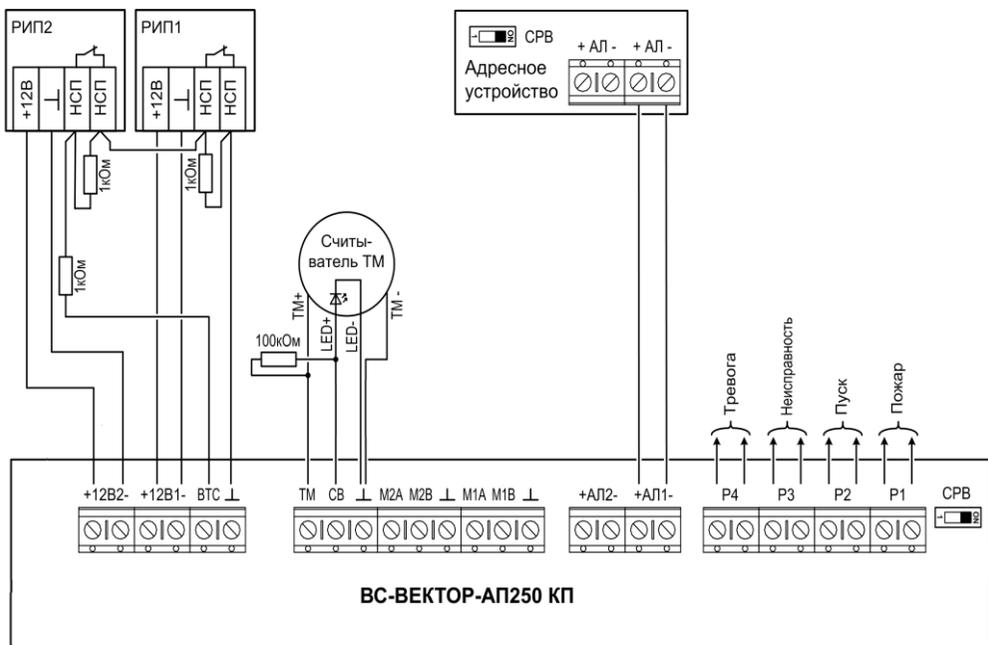
Рис. А4. Схема подключения КП, подключение АУ при креплении
