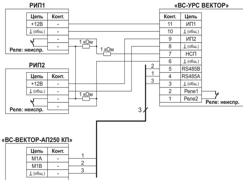
Рис. А5. Схема подключения УРС
