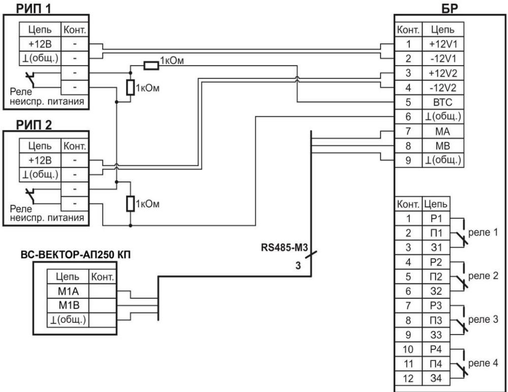
Рис. А7. Схема подключения БР
