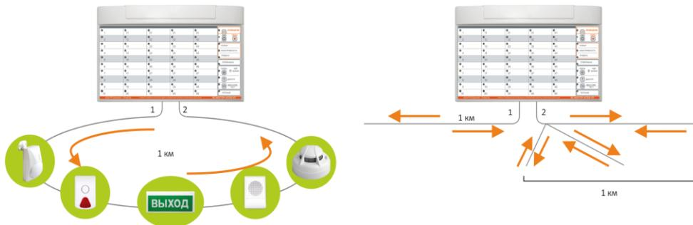
Адресные извещатели питаются от адресной линии. Адресные оповещатели питаются от адресной линии в дежурном режиме, а в режиме оповещения они для питания подключают встроенную батарею дополнительного питания типа CR123A, 3В.
