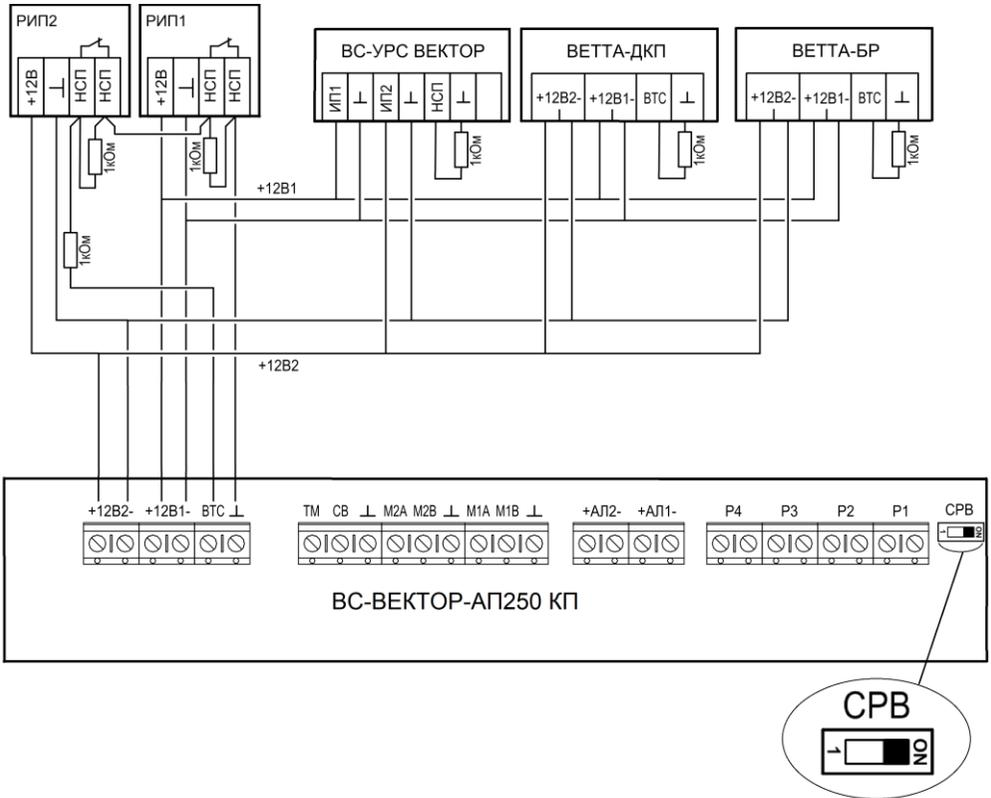
Рис.А1. Схема питания прибора
