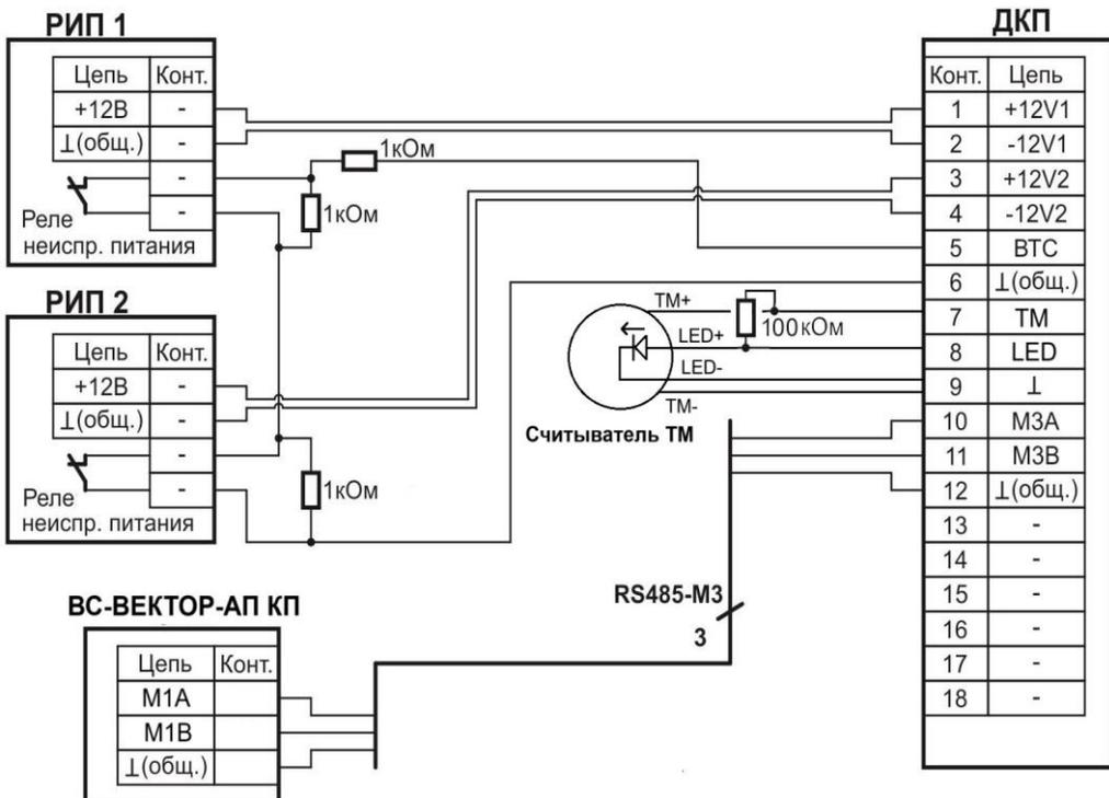
Рис. А6. Схема подключения ДКП
