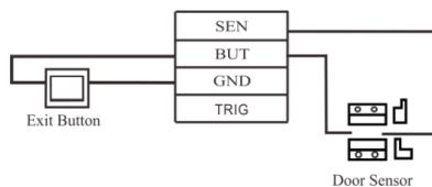
Door sensor/Exit button – Дверной сенсор/Кнопка выхода
