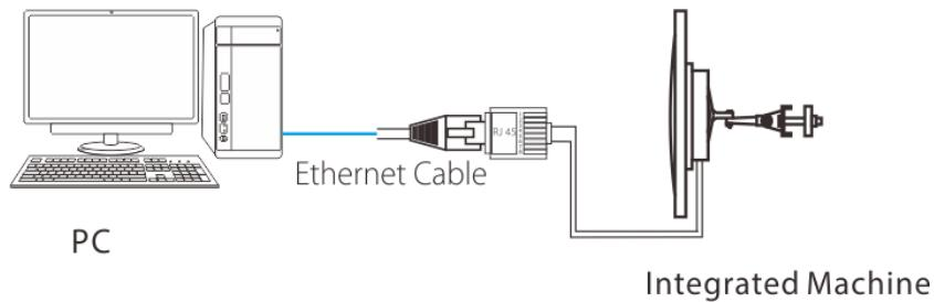
Соедините RJ45 порт интегрированного устройства к Ethernet порту ПК.
