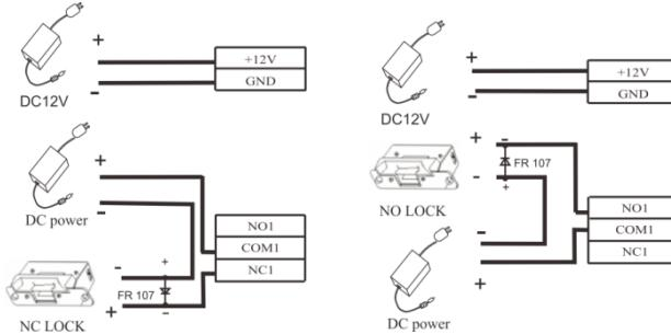
(1) Система поддерживает NO LOCK и NC LOCK. NO LOCK (нормально открыт при наличии питания) соединен с NO terminal, и NC LOCK соединен с NC терминалом.
