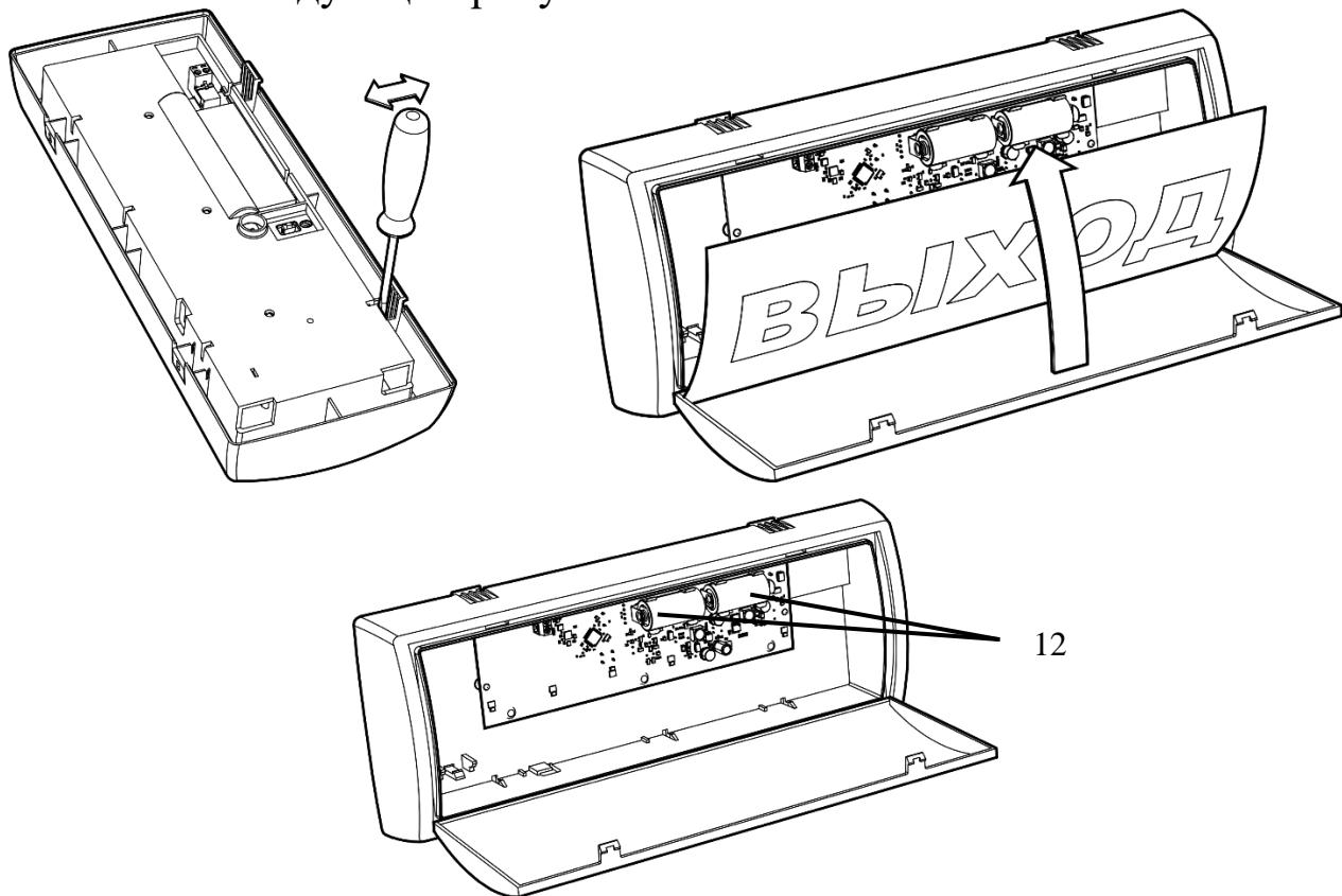
Разъемы для подключения основной ("Primary") и резервной ("Secondary") батарей (12) расположены на плате под прозрачной крышкой (6) с экраном (5). Для включения устройства необходимо извлечь изолирующие вставки из указанных разъёмов. Установка/замена батарей также производится при снятой прозрачной крышке.
