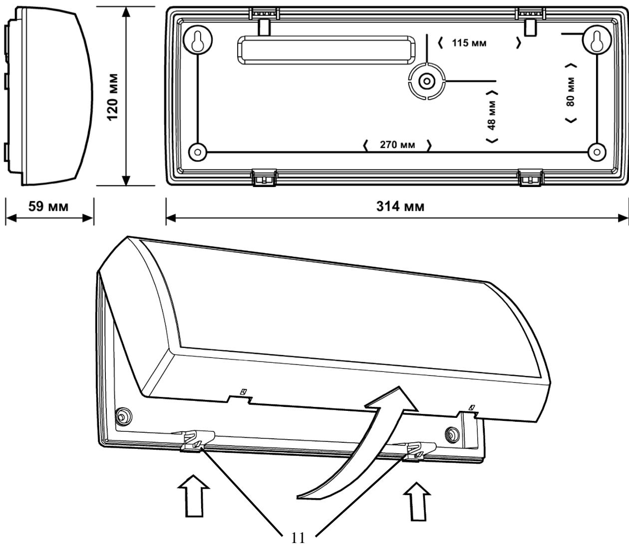
Подсоединение внешнего источника питания и программирование производится со снятым основанием.
