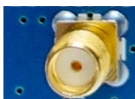
Рисунок 3.1 — SMA-разъем для подключения LTE-антенны
