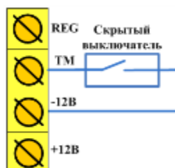
Рисунок 3.4 — Схема подключения скрытого выключателя
