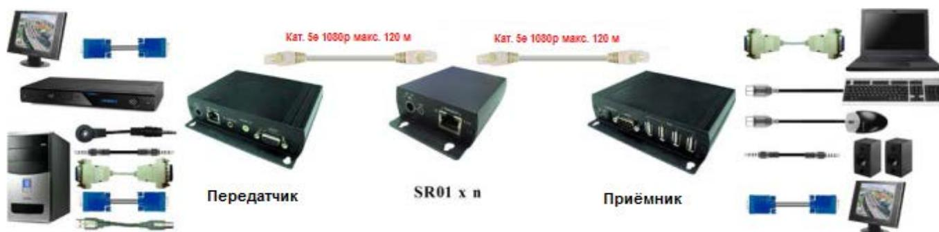
Рис. 5 Схема подключения SR01 совместно с VKM03.
