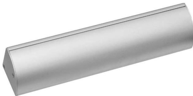
Кронштейн LC типа применяется для крепления электромагнитных замков надверной коробкой двери, открывающиеся наружу, когда электромагнитный замок нельзя установить непосредственно на коробку. Данный кронштейн имеет крышку, которая позволяет скрывать монтажные элементы замка, что придает более эстетичный внешний вид и защищает проводку от преднамеренного повреждения.
