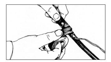
1. На расстоянии 2000 мм от конца на оболочке кабеля делают круговой и продольный надрезы. Затем на защищенном участке стальной оболочки проводом ПКСВ 2х0,5 делают два плотных витка, концы с натяжением плотно скручивают. Поверх проволочного бандажа наматывают с 50 % перекрытием два слоя ленты 88Т. После кругового и продольного разрезов внутреннюю оболочку удаляют с сердечника кабеля.
