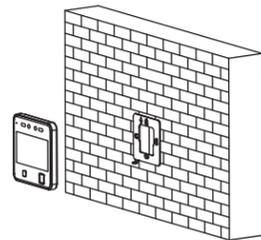
**3** Зафиксируйте устройство на монтажной пластине при помощи 1 винта, поставляемого в комплекте (KM3X6-H2-SUS).
