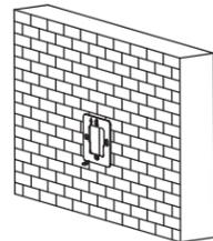
**2** Проложите кабели через отверстие для кабеля на монтажной пластине и подключите кабели внешних устройств к разъемам. Разместите устройство на монтажной пластине.
