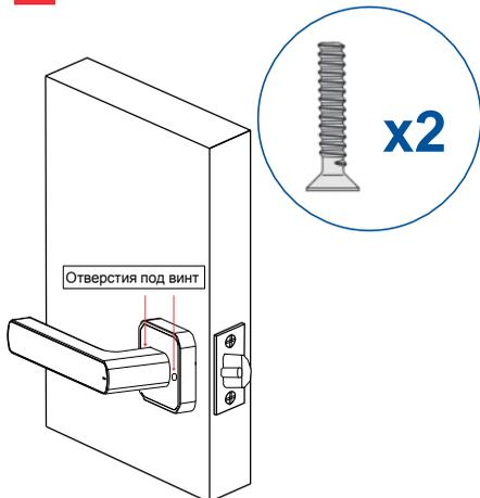
Приложите внутреннюю нажимную ручку к двери. Совместите отверстия со шпильками, затем с помощью прилагаемых в комплекте 2 (двух) винтов закрепите внутреннюю и наружную ручки на двери.
