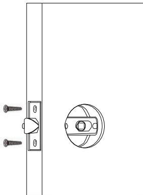
Установите защелку и закрепите ее винтами. Установите ответные планки и также закрепите их винтами.
