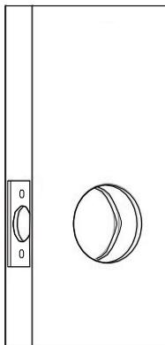
Отметьте на двери места для отверстий, используя шаблон, затем просверлите отверстия.
