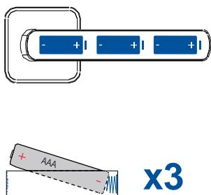
С помощью отвертки в комплекте отвинтите крышку отсека для батареек, расположенного во внутренней ручке. Затем установите батарейки (сначала отрицательный полюс). Закройте крышку отсека.
