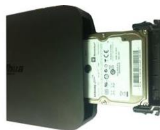
3 Вставьте жесткий диск в устройство.
