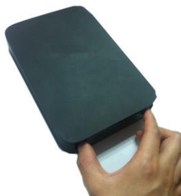
1 Извлеките кронштейн жесткого диска
