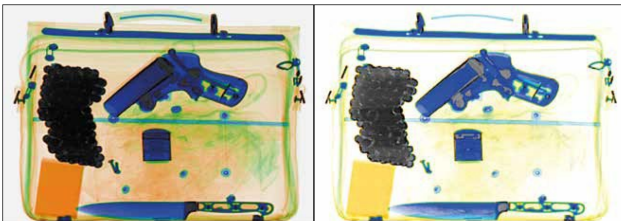
Рис. 20. Преобразование изображения предметов из материалов большой плотности.
