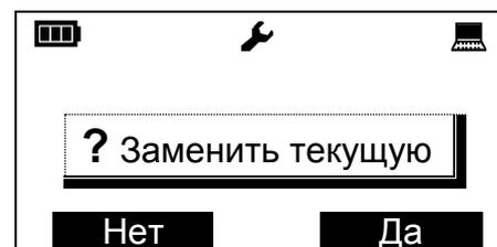
При утвердительном ответе пульт приступает к процедуре считывания свойств всех устройств радиосистемы. Считывание проводится автоматически последовательно из каждого радиорасширителя системы, начиная с координатора радиосети<sup>1</sup> (PP 0).
