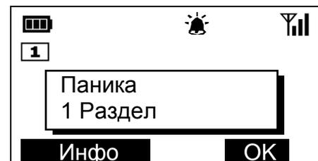
Выключение звуковой сигнализации возникших событий о неисправностях или тревогах произойдет автоматически по истечении 2 мин либо при нажатии любой клавиши пульта.
