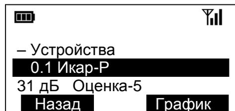
При нажатии экранной клавиши < График > откроется окно с графическим отображением истории качества связи с устройством.
