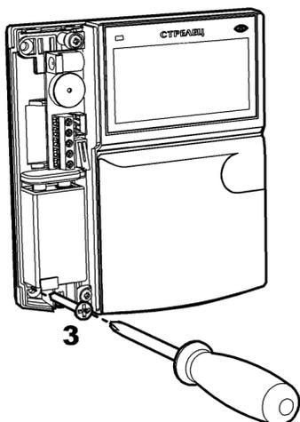
3. Для крепления пульта ввинтите шуруп в отверстие 3 в его нижней части.
