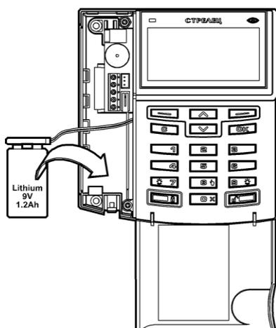
Батарея подключается к соединительной клеммной колодке и устанавливается в батарейный отсек.
