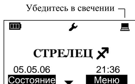
5. В противном случае проверьте наличие питания радиорасширителя (светодиодный индикатор расширителя должен светиться), правильность соединения пульта с ним посредством интерфейса RS-232 и убедитесь в том, что интерфейс RS-232 пульта включен (должно быть Меню -> Настройки -> Радио -> Выкл.).
