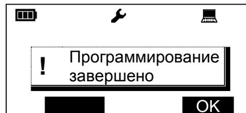
Запрограммируйте последовательно все дочерние устройства радиорасширителя. Для программирования дочернего устройства выделите его в меню:
