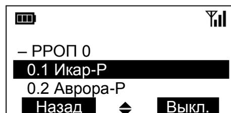
При успешном выполнении операции назначение экранной клавиши изменится на < **Вкл.** > и, по истечении периода передачи контрольных сигналов извещателя (по умолчанию – 32 с), возникнет окно с сообщением о включении обхода адреса.
