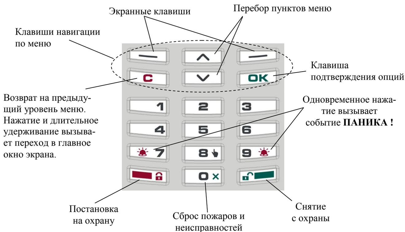
Специализированные клавиши  $\langle \text{🔒} \rangle$  (взять) и  $\langle \text{🔓} \rangle$  (снять) предназначены для постановки на охрану и снятия с охраны соответственно. С помощью клавиши  $\langle \text{0 X} \rangle$  выполняется сброс пожарных тревог и неисправностей.
