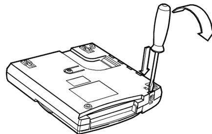
Установка пульта выполняется по-разному в зависимости от необходимости использования датчика отрыва от стены. Датчик отрыва от стены предназначен для контроля несанкционированного открепления пульта от стены. При срабатывании датчика отрыва от стены на радиорасширитель – координатор радиосети (PP 0) передаётся извещение "Взлом".
