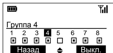
Включенные группы отмечены точками на экране. Для включения/выключения групп переместите указатель с помощью клавиш < ⬅️ > и нажмите экранную клавишу < Вкл. > / < Выкл. >.
