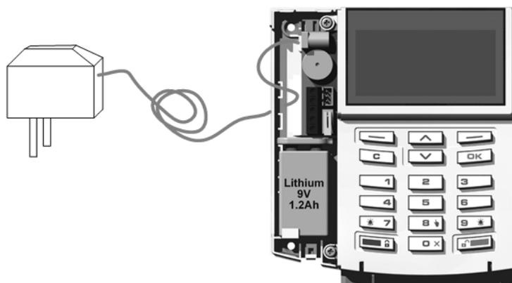
Сетевой адаптер подключается посредством унифицированного разъёма.
