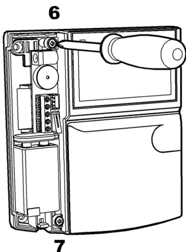
При подключении внешнего источника питания (блока питания DC 10,8-27 В или сетевого адаптера DC 12-27 В, АС 9-24 В) пропустите соединительные провода через отверстие в основании пульта.
