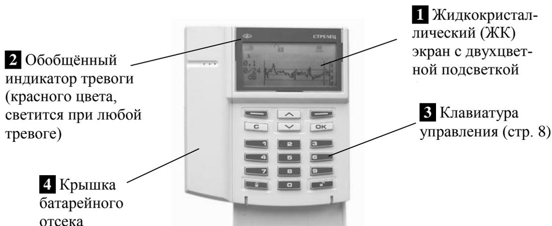
Для снятия крышки батарейного отсека необходимо использовать отвёртку.
