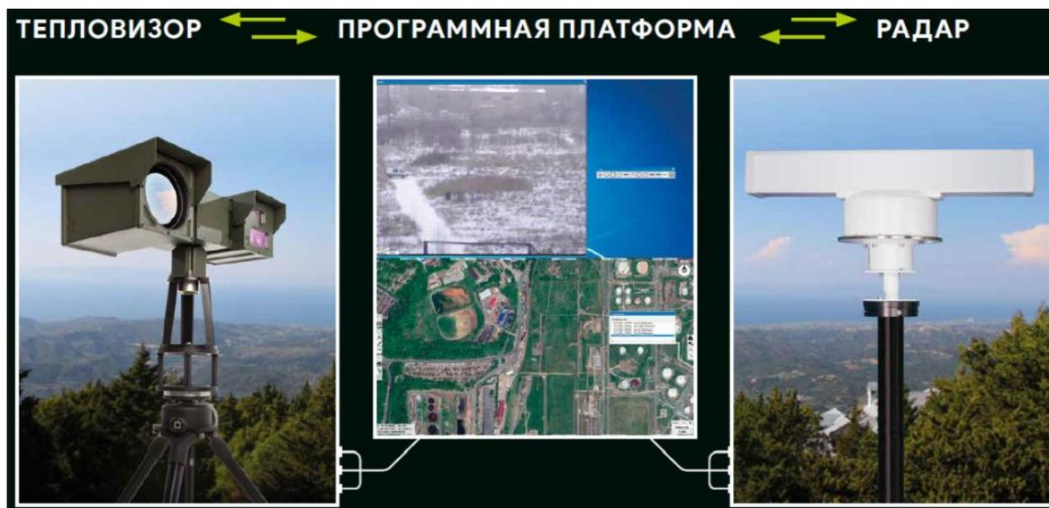
Радар обнаруживает объект и при помощи программного обеспечения (ПО) направляет тепловизор в его сторону. Работает с неограниченным количеством зон слежения на карте. Разметка доверенных зон позволяет не выдавать сигналы тревоги там, где это не требуется. Например, при охране взлётно-посадочной полосы ПО позволяет обнаруживать объекты только вокруг неё, исключая саму полосу.
