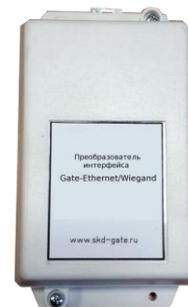
Конфигурация преобразователя происходит с помощью специальной утилиты — программы, работающей под управлением операционной системы MS Windows. В программе задается начальный IP адрес устройства и другие параметры связи.
