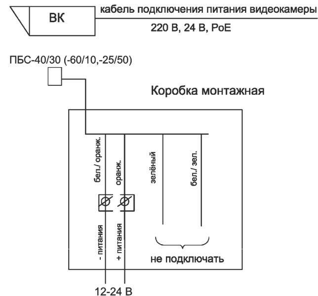
Рис. 4 б Схема подключения прожектора в режиме "включение/выключение ПБС от встроенного сенсора освещенности"
