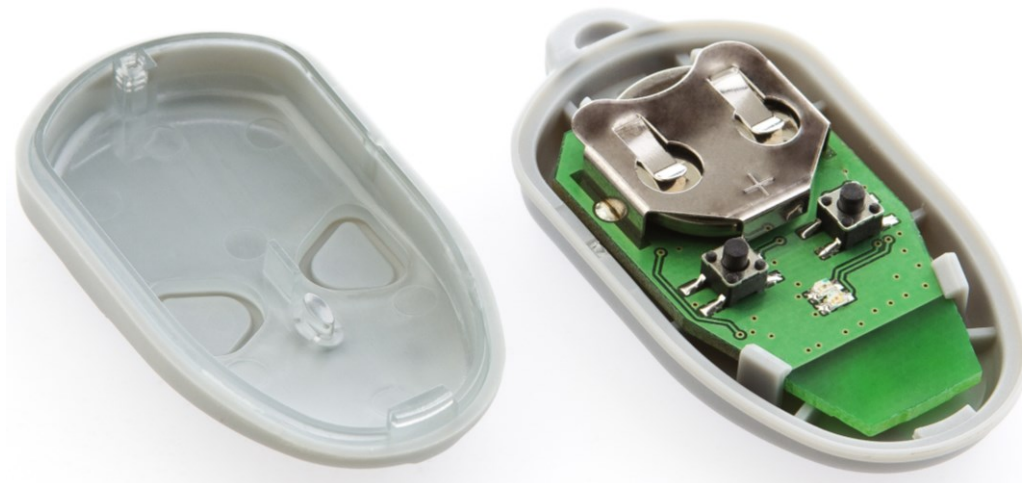
Рисунок 2. Идентификатор со снятой крышкой. Видна батарея питания
