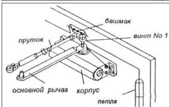
4. Установите основной рычаг на поворотную ось доводчика и закрепите его винтом № 1.
