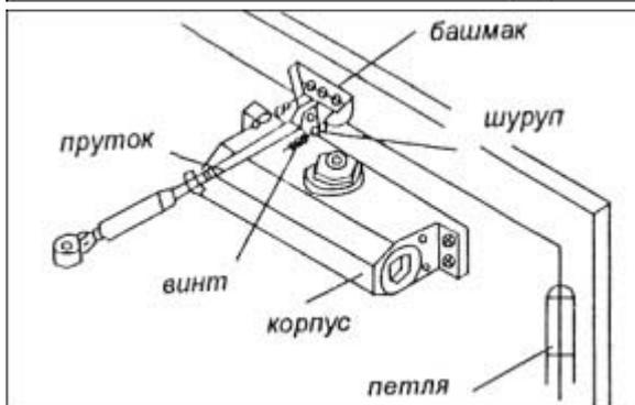
3. Отсоедините пруток с резьбой и крепежным башмаком от основного рычага и установите его на дверь или косяк.
