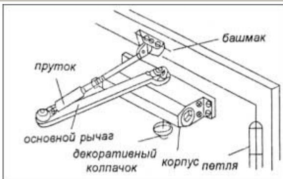
6. Наденьте декоративный колпачок на противоположную часть поворотной оси доводчика.
