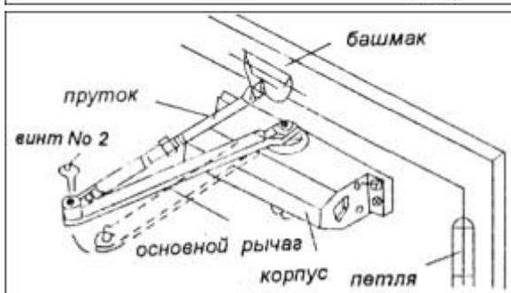
5. Регулируя длину прутка, убедитесь, что он установлен перпендикулярно двери при соединении с основным рычагом и закрепите их винтом № 2.
