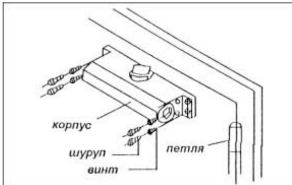
2. Установите корпус на дверь или косяк четырьмя шурупами или винтами (на металлическую дверь) так, чтобы винты регулировки были направлены к петлям.
