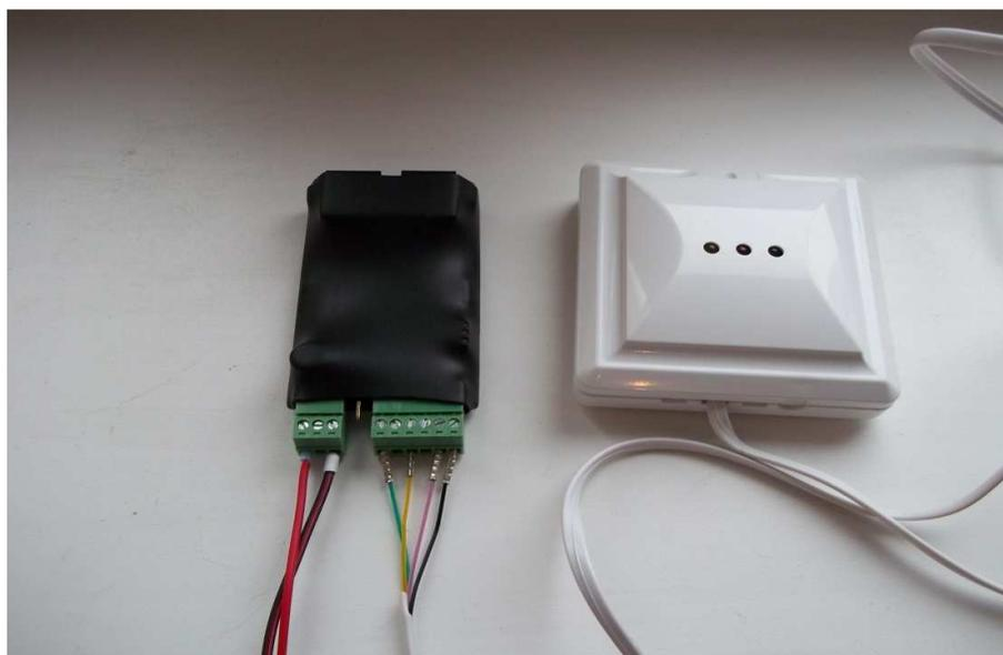
Рисунок 23 - Подключенный датчик разбития стекла «Стекло-3»
