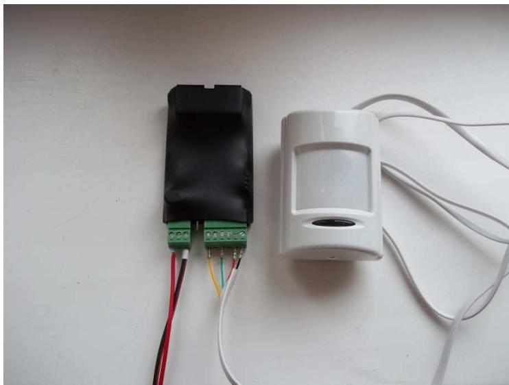
Рисунок 25 - Подключенный датчик Pyronix Colt QuaD PI
