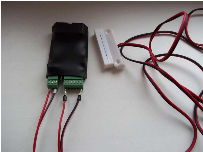
Рисунок 19 - Подключенный датчик открытия/закрытия двери
