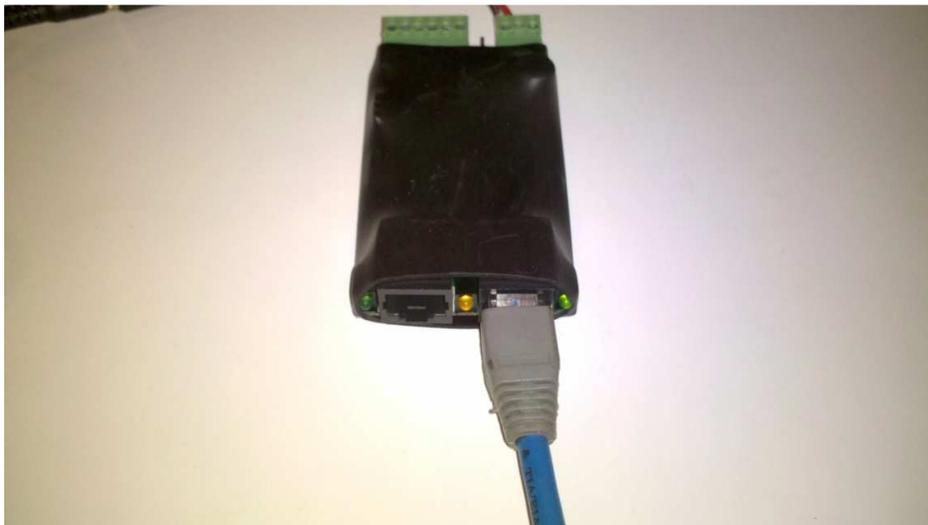
Рисунок 7 - Подключена сеть; горит индикатор питания и светодиод 2
