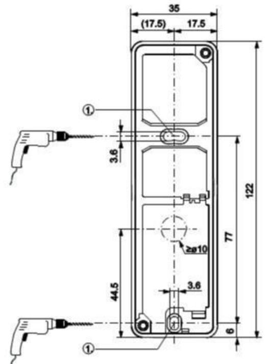
2. Изготовьте отверстие под кабель или выломайте язычок на корпусе антенны при накладном монтаже кабеля.
