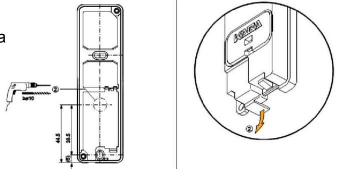
3. Закрепите заднюю стенку на ровной поверхности. Задняя стенка не должна быть деформирована. Протяните кабель считывателя через заднюю стенку.
