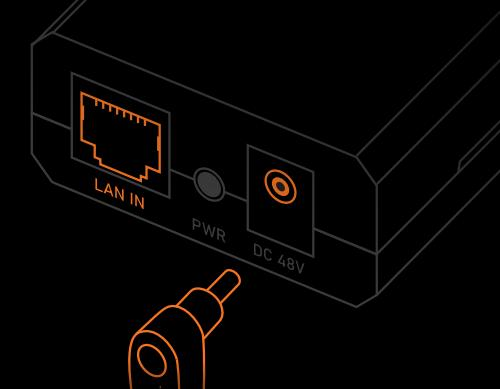
Затем подключите PoE-адаптер в розетку с помощью блока питания
