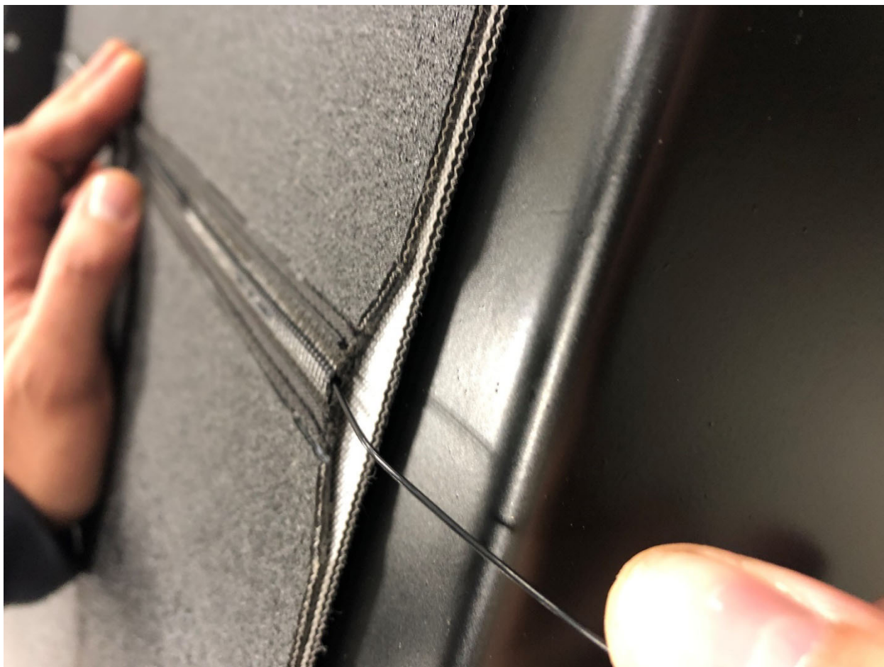
Рис. 4-11. Стыковка концов конвейерной ленты и установка замка.
