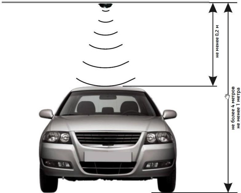
Датчик устанавливается сверху над точкой обнаружения автомобиля, таким образом, чтобы при остановке автомобиля под датчиком была ровная поверхность (крыша, или капот, но не лобовое и заднее стекло или бок автомобиля). Угол излучения датчика составляет  $15^\circ$ , поэтому рядом с датчиком не должны находиться объекты способные отразить волну (трубы, кабельные трассы, светильники). Минимальная высота от автомобиля до датчика 20 сантиметров.
