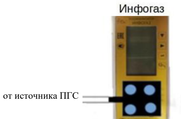
Рис. 3.1. Подача ПГС в адаптер при проверках
