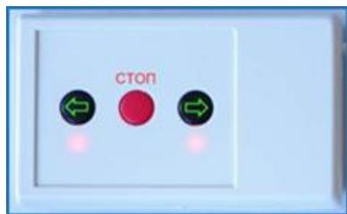
Пульт СИСТЕМНЫЙ выполнен в виде небольшого настольного прибора в корпусе из пластика. На лицевой панели корпуса расположены три кнопки управления: красная кнопка СТОП для установки турникета в режим «Закрыт», и две зеленые кнопки ← и → для установки однократного прохода в выбранном направлении. Рядом с кнопками расположены соответствующие световые индикаторы.
