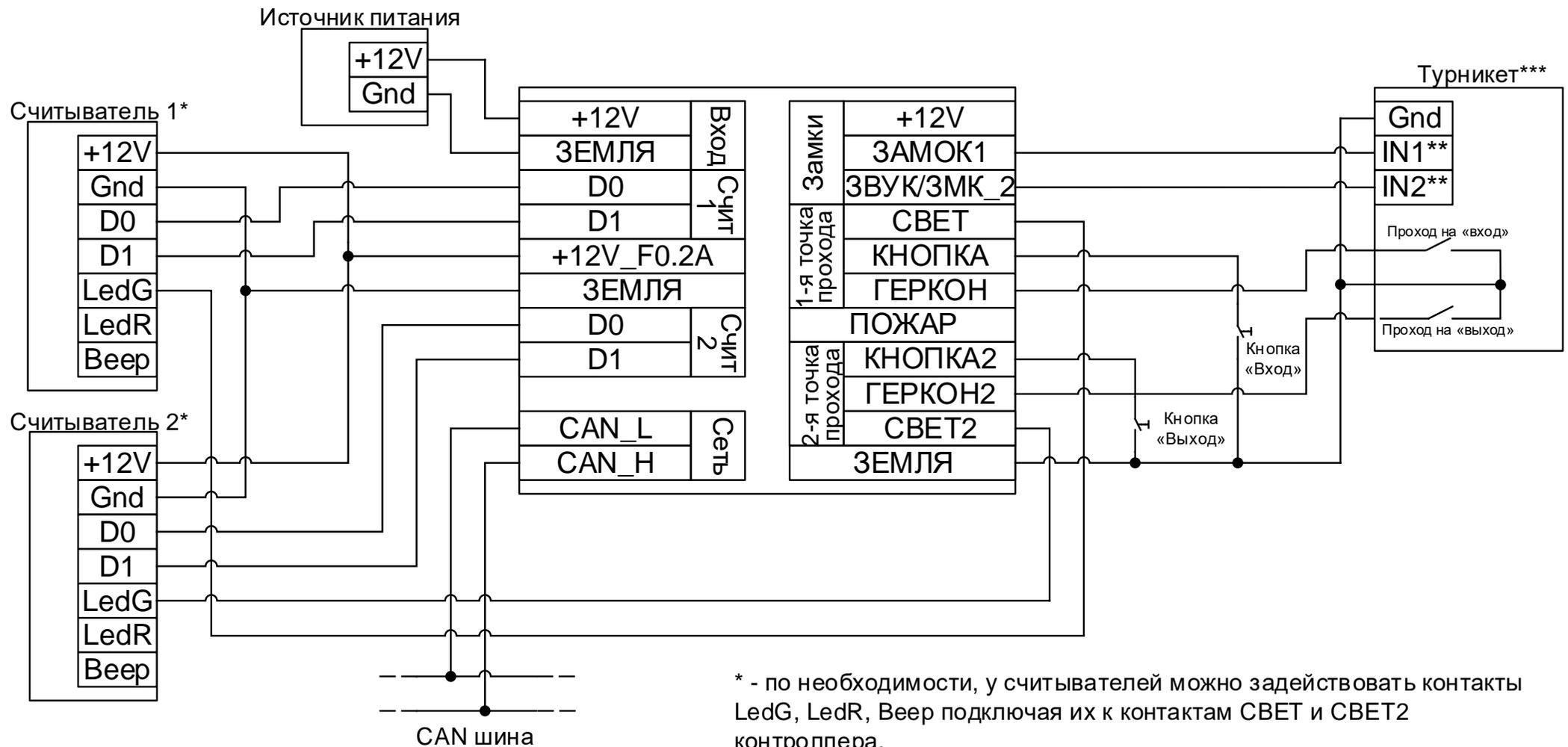
\* - по необходимости, у считывателей можно задействовать контакты LedG, LedR, Beep подключая их к контактам СВЕТ и СВЕТ2 контроллера.
