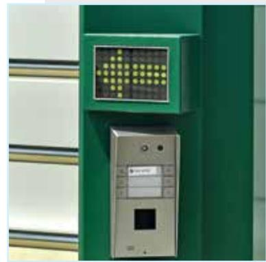
**RFIDreader** – встроенный RFID считыватель
