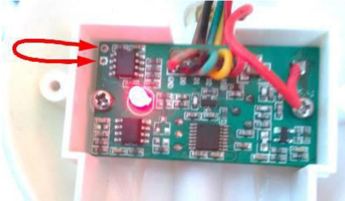
5. Пока светится светодиод следует нажать на кнопку «Стоп» (средняя кнопка) программируемого радиобрелока на 0,5-1 секунду, при этом светодиод мигает несколько раз, что означает успешную запись кода радиобрелока в память приемника.
