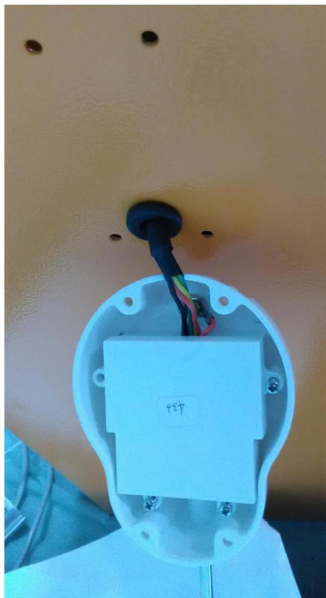
2. Открыть радиоприемный модуль, отвинтив четыре винта крышки
