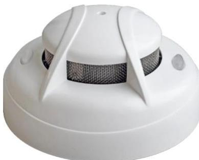
Дымовая камера пожарного извещателя «ДИП-220А ВЕКТОР» служит для измерения оптической плотности воздушной среды с целью обнаружения фактора пожара в виде задымления. Однако вызвать срабатывание извещателя может не только задымление, но и пыль или взвеси, которые постепенно накапливаются в дымовой камере, оседая на ее внутренней поверхности.
