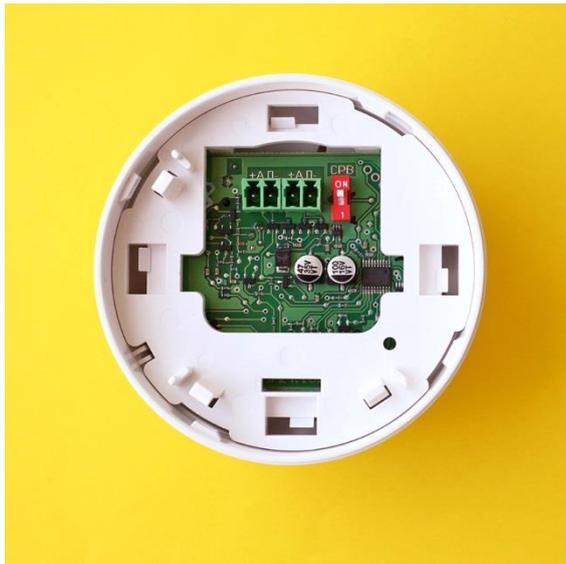
2.2. Извлеките основание с печатной платой и дымовой камерой из корпуса:
