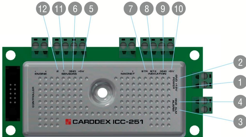
Рисунок 6 – Модуль управления «ICC-251»
