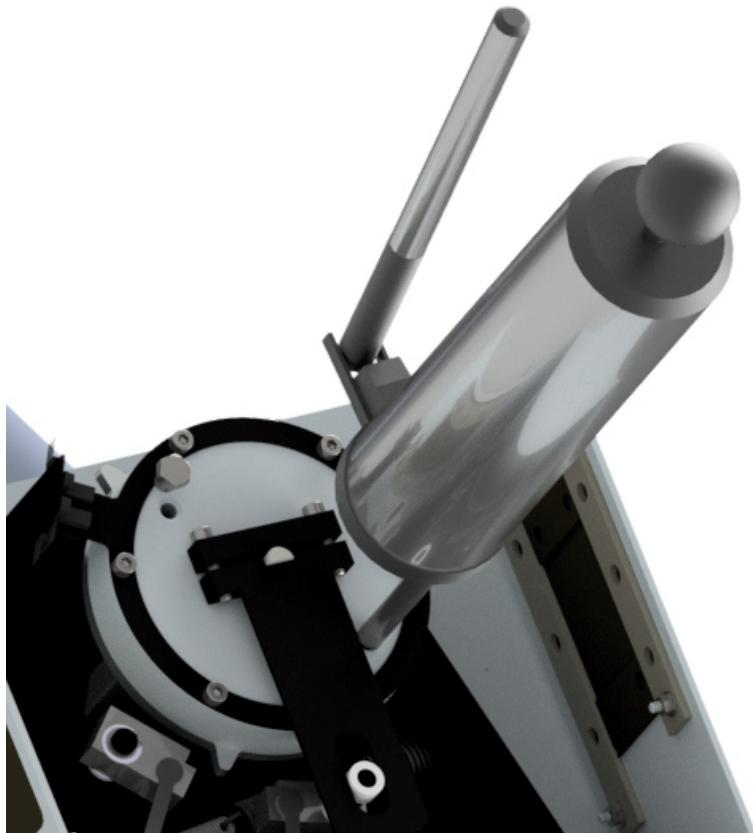
Рисунок 27 – Доливка демпферной жидкости
