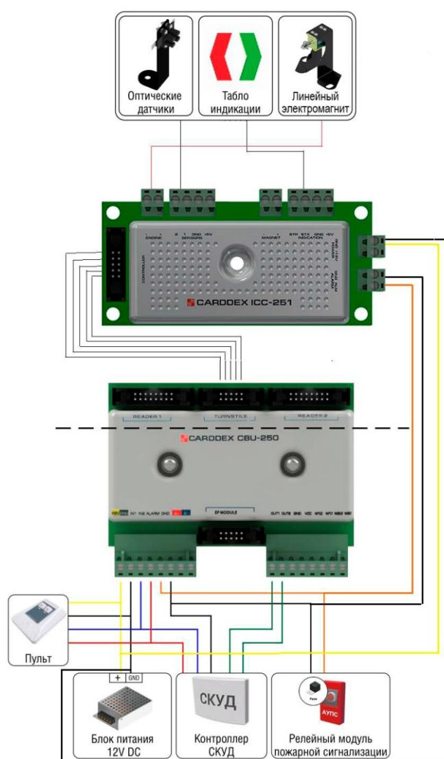
Рисунок 17 – Схема основных подключений турникета
