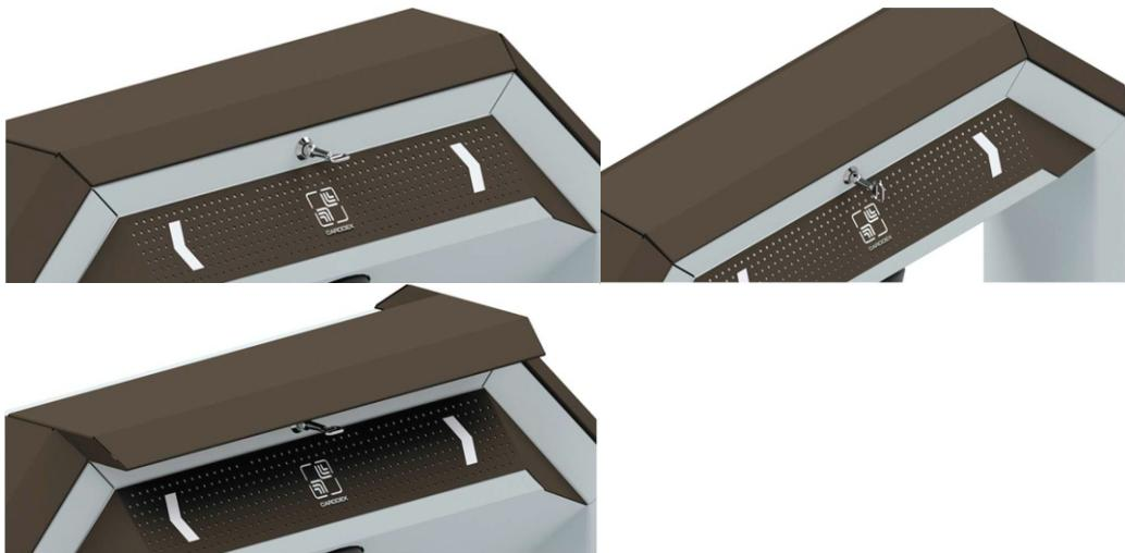
Рисунок 22 – Демонтаж верхней крышки турникета
