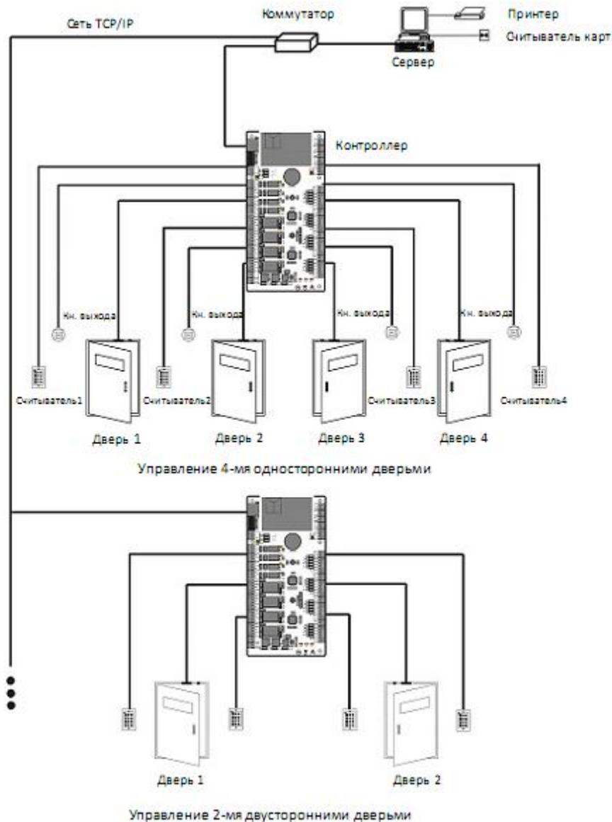
Схема подключения контроллера
