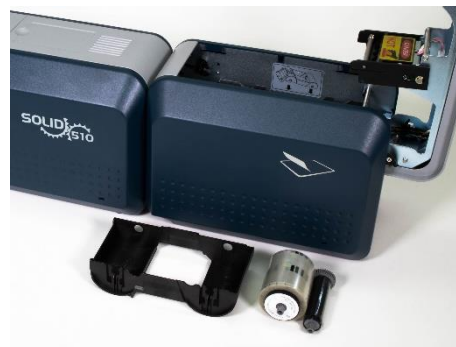
Рис. 21 Удалите картридж с ламинационной лентой
