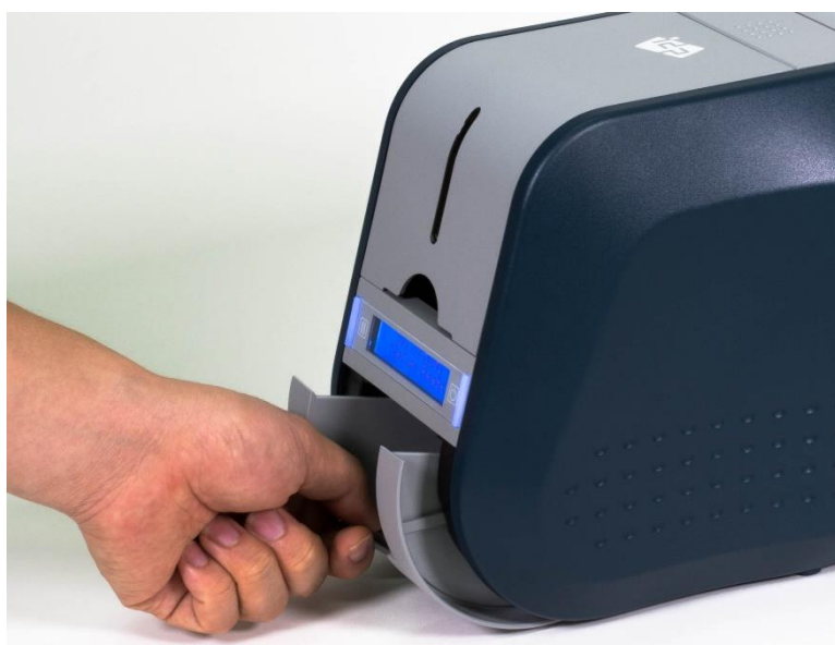
Рис. 32 SOLID-510 Изъятие лотка и разведение в стороны
