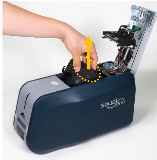
Рис. 14 Изъятие картриджа с печатной лентой
