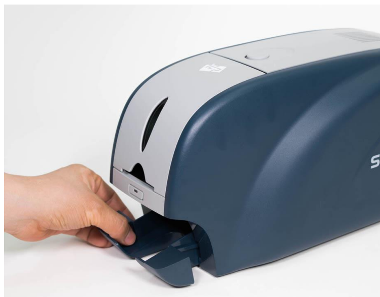
Рис. 24 ADVENT SOLID-310 «Разделение» лотка выдачи карт
