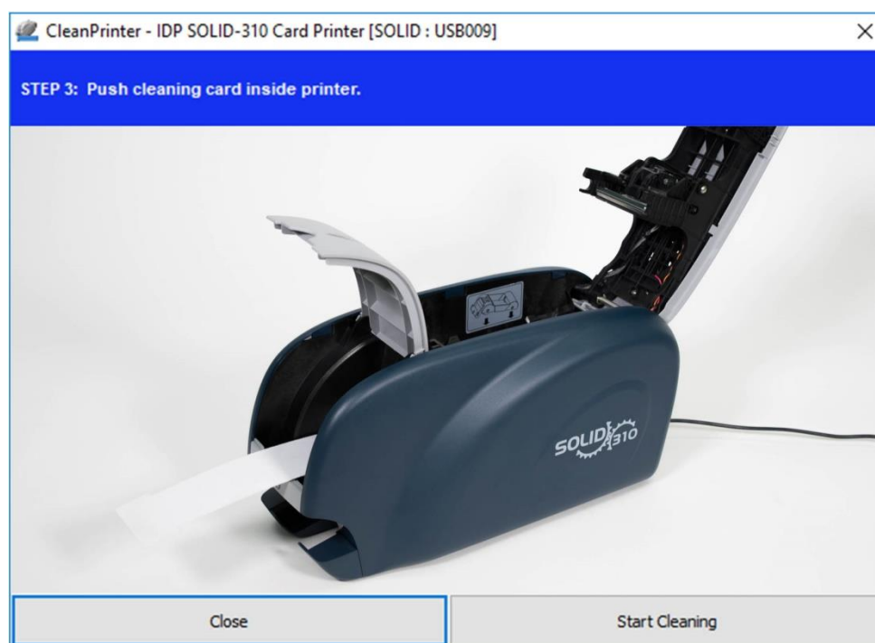
Рис. 90 Очистка Принтера Шаг 3
