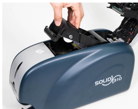
Рис. 14 Установите картридж с лентой
