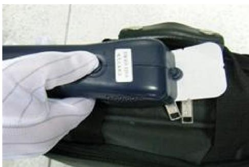
**Рис. 5-17: Отбор пробы вакуумным пробоотборником**
