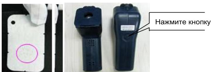
**Рис. 5-13: Салфетка вакуумного отбора проб (слева) и вакуумный пробоотборник (справа)**
