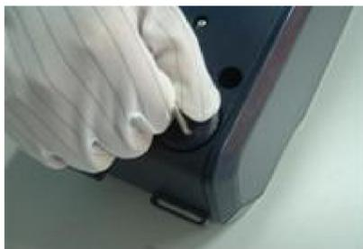
**Рис. 6-5: Открутите крышку воздушного фильтра**
