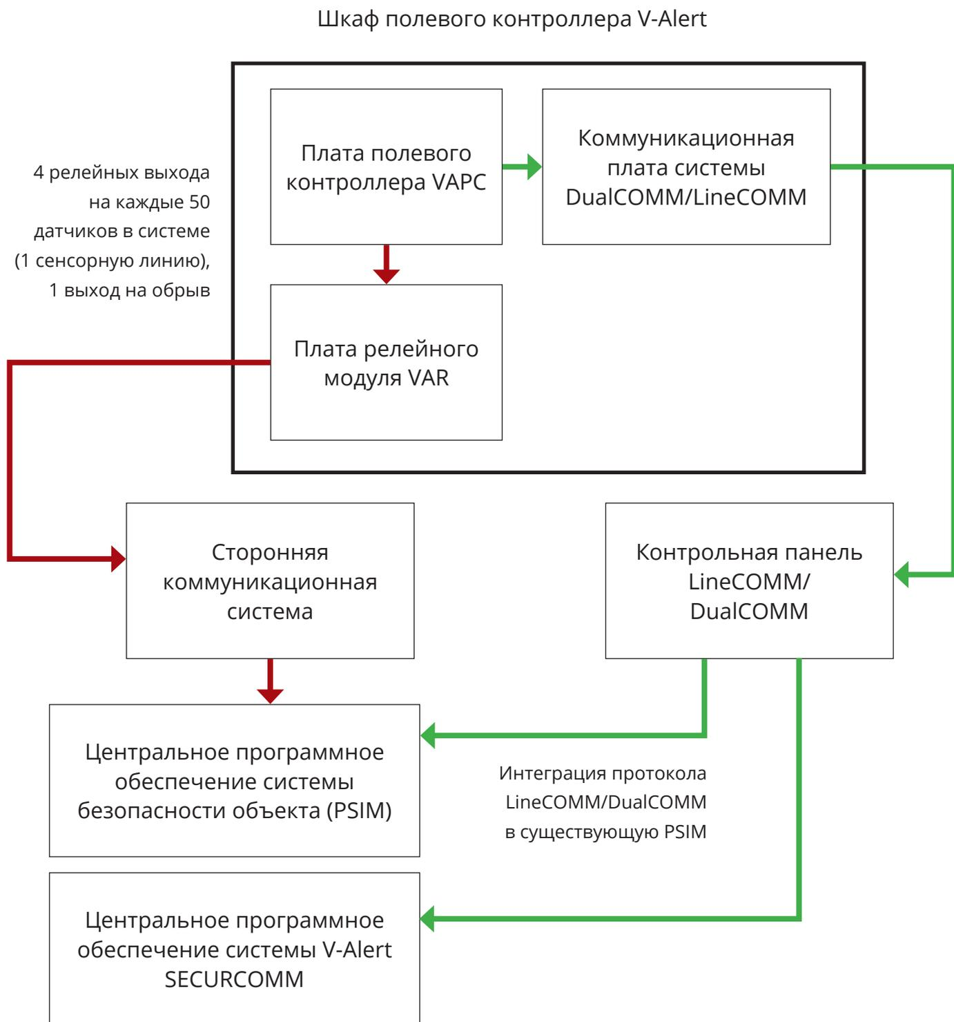
→ Построение системы с использованием LineCOMM/DualCOMM позволяет получать тревожные сигналы от каждого отдельного датчика в системе
