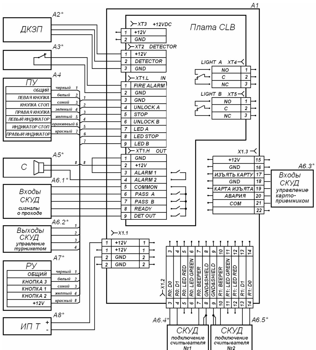
Рисунок 11 Схема подключения турникета и дополнительного оборудования<sup>1</sup>
