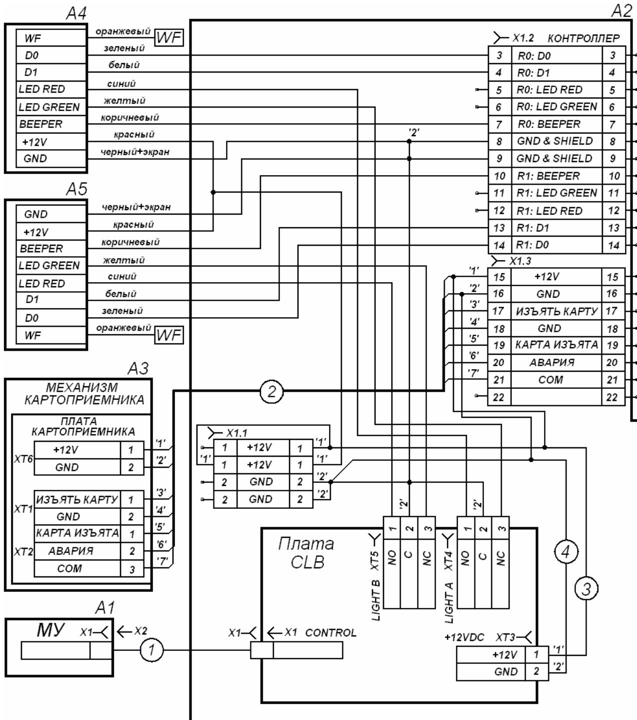
Рисунок 12 Схема внутренних соединений турникета<sup>1</sup>
