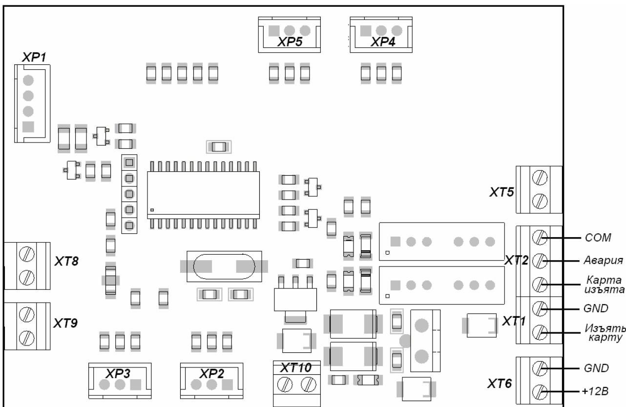
**Рисунок 9 Внешний вид платы картоприемника PERCo-PA-450**
