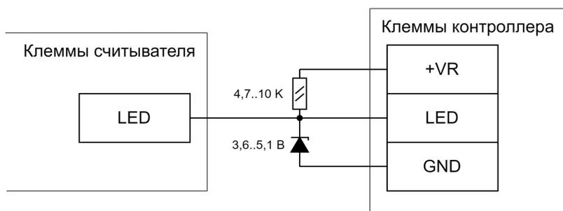
Подключение линии управления индикацией считывателя, управляемой подачей 5В.
