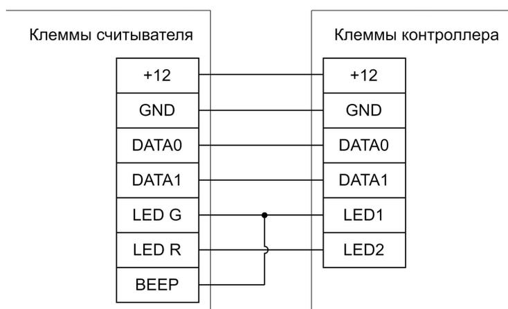
Пример подключения считывателя с напряжением питания, равным напряжению питания контроллера.
