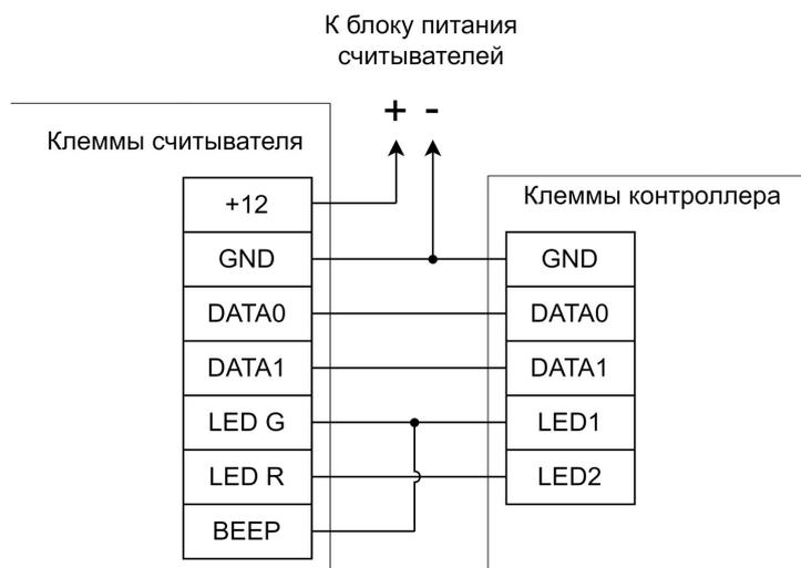
Пример подключения считывателя с напряжением питания, отличающимся от напряжения питания контроллера или считывателей, потребляющих ток больше 200 мА.
