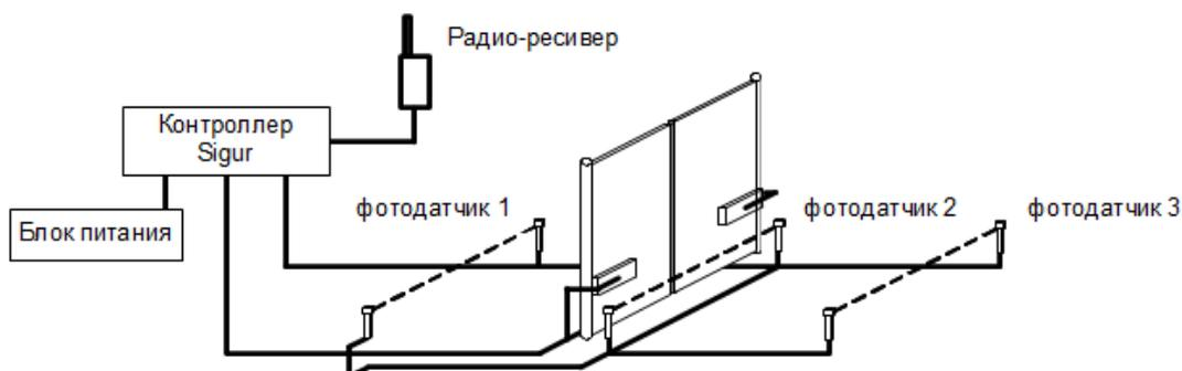
Запрос проезда осуществляется с помощью нажатия кнопки на радиобрелоке. Для предотвращения случайного открывания ворот обработка запроса производится контроллером только при наличии машины в зоне действия датчика 1 или 3. Направление движения (въезд или выезд) определяется по датчику, активному в момент нажатия на кнопку брелока.
