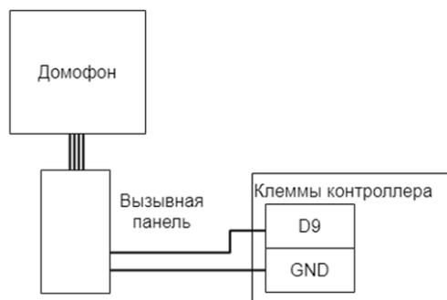
Пример подключения домофона с «сухим контактом» (реле).
