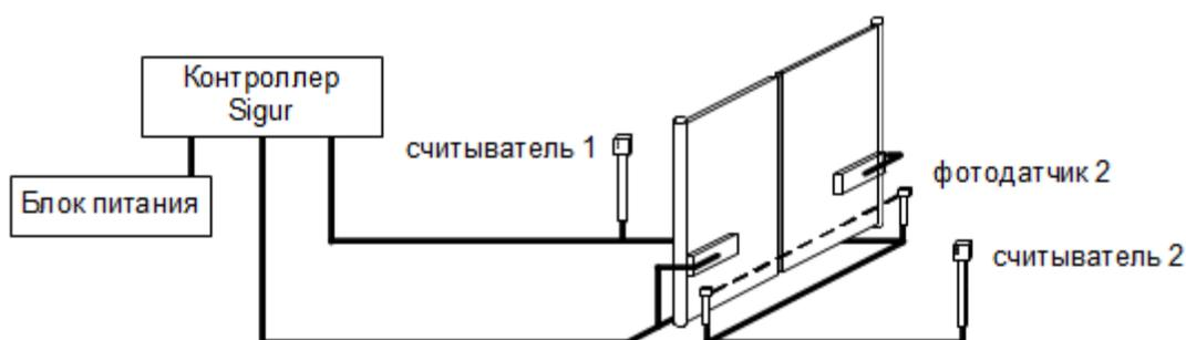
Запрос проезда осуществляется с помощью поднесения ключей – электронных карточек водителей автомашин или считывания активных меток, установленных на каждой машине. Для данной конфигурации рекомендуется использование считывателей повышенной дальности. В данном примере датчики наличия автомобиля перед воротами не установлены. Такой вариант установки возможен, но не рекомендуется, т. к. понижается безопасность работы автоматизированных ворот.
