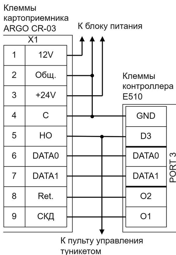
Пример подключения ARGO CR-03, TVER-7x в направлении «Выход».
