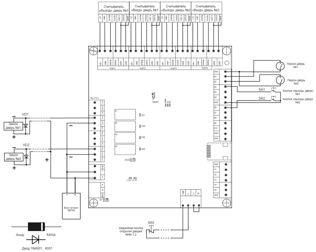
Пример подключения двух дверей с замками импульсного типа управления.
