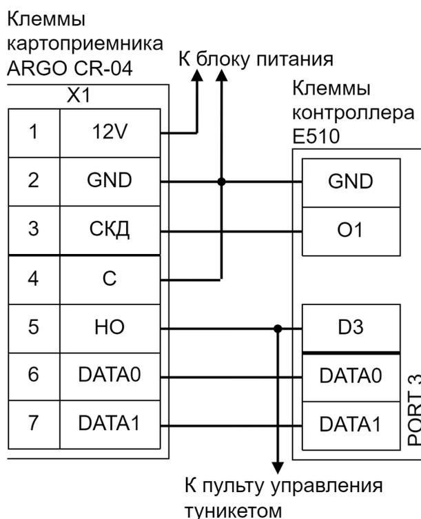
Пример подключения ARGO CR-04 в направлении «Выход».
