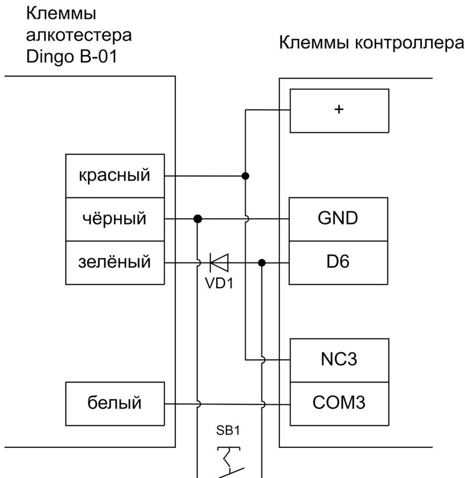
VD1 – диод Шотки или германиевый (с минимальным падением напряжения).
