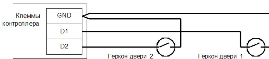
Подключение датчиков открытия дверей.
