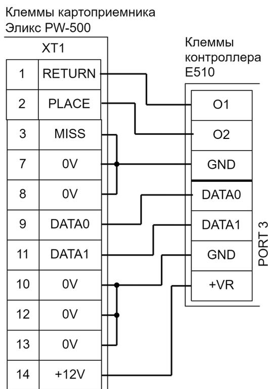
Пример подключения Эликс PW-500 старого образца в направлении «Выход».
