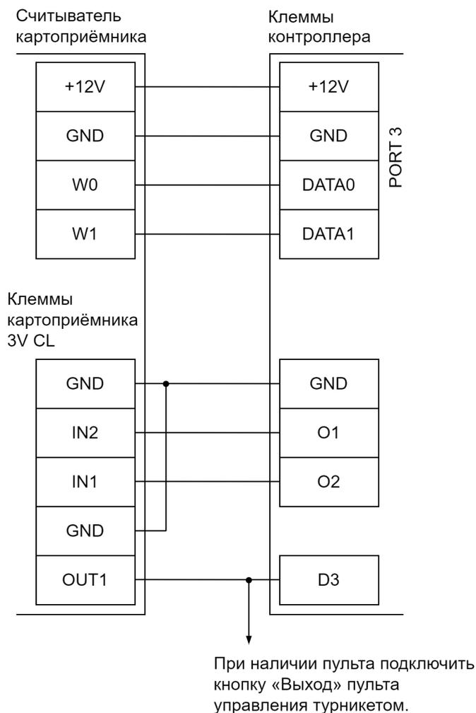
Пример подключения картоприёмника 3V CL к контроллеру.
