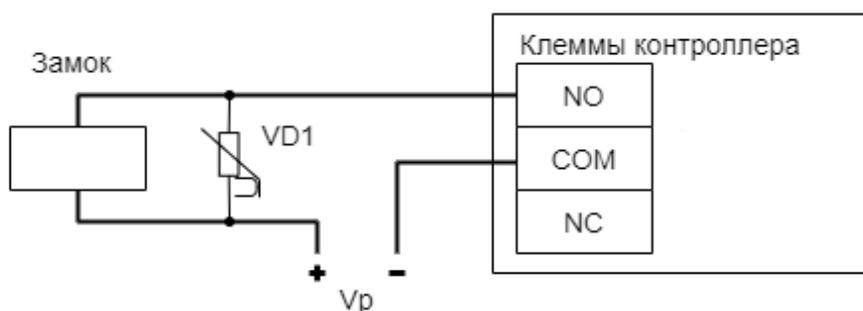
Пример подключения электромеханического замка для первой двери.
