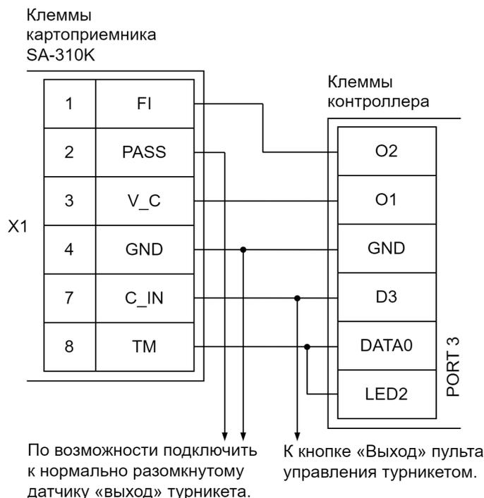
Пример подключения SA-310K в направлении «Выход».
