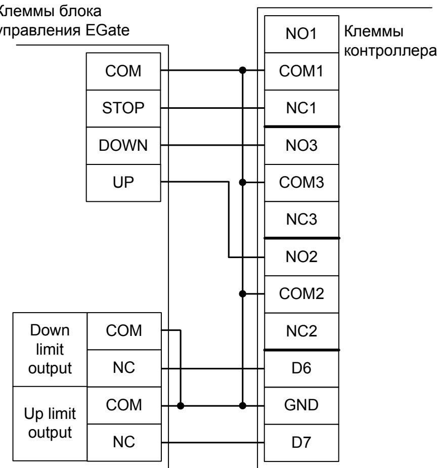
Рисунок 214. Подключение блока управления EGate.
