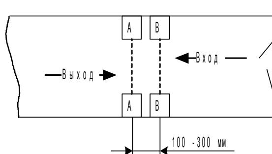
**Рисунок 19. Пример расположения датчиков прохода в коридоре.**
