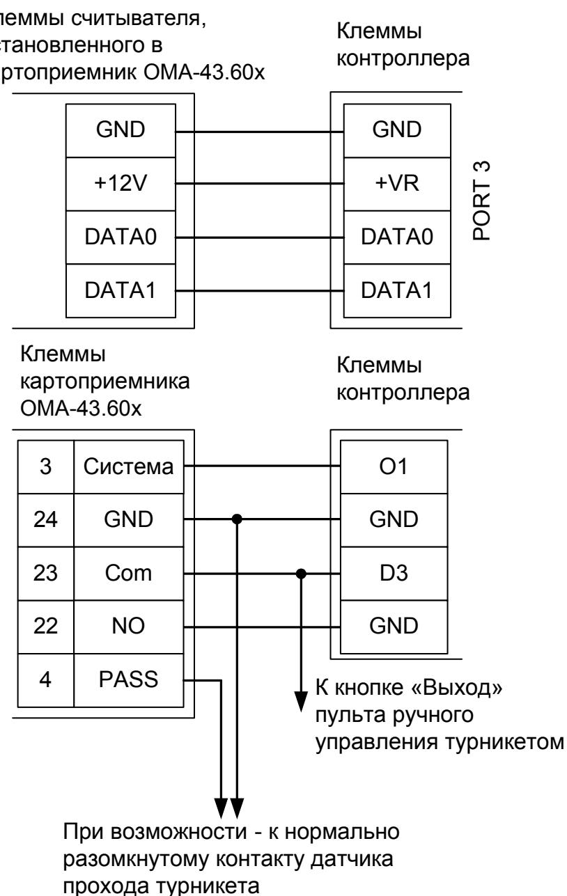
Рисунок 46. Пример подключения ОМА-43.60x в направлении «выход».
