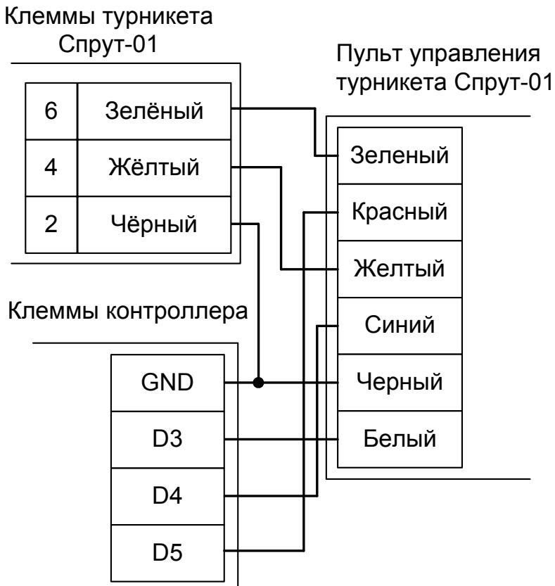
Рисунок 134. Первый вариант подключения пульта управления «Спрут-01».
