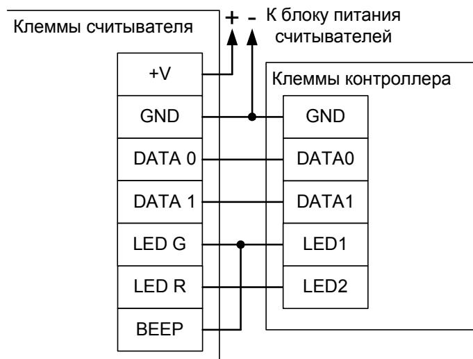
**Рисунок 5. Пример подключения считывателя с напряжением питания, отличающимся от напряжения питания контроллера или считывателей, потребляющих суммарный ток больше 500 мА.**
