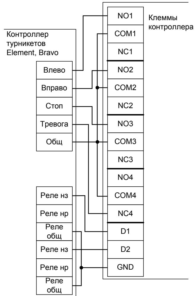
Рисунок 140. Element и Bravo.
