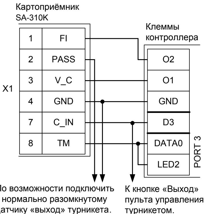
Рисунок 58. Пример подключения SA-310K на выход турникета.
