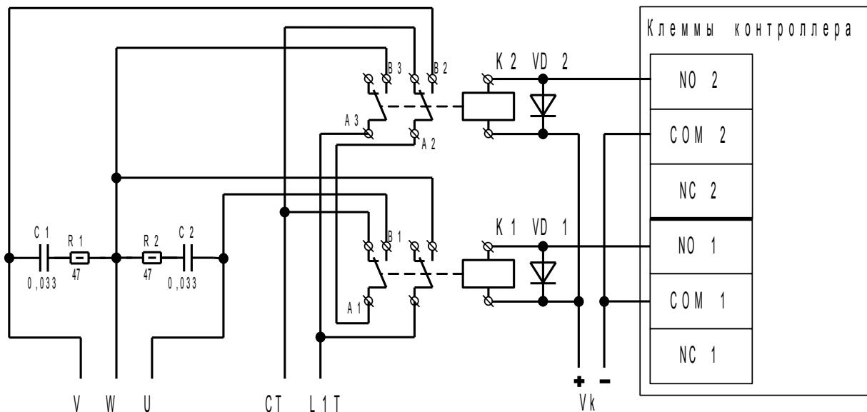
Рисунок 155. Подключение к мотор-редуктору FAST, KRONO, ATI, FERNI.
