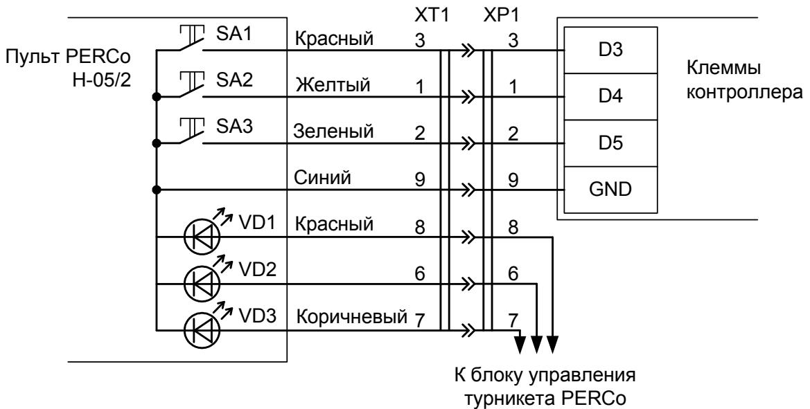
Рисунок 86. Пульт управления PERCo H-05/2 с разъемом
