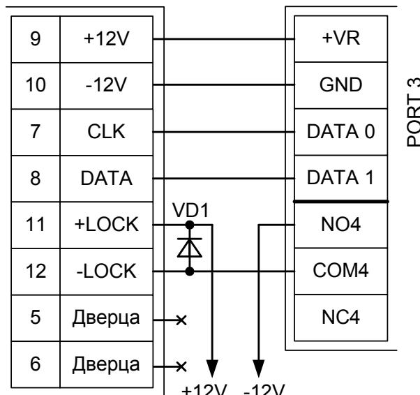
Рисунок 43. Пример подключения «Кодос» в направлении «выход».
