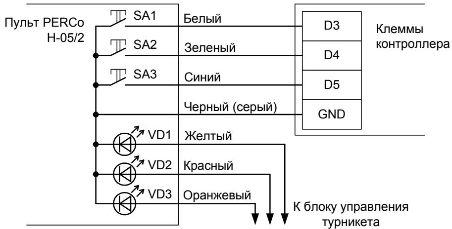
Рисунок 85. Пульт управления PERCo H-05/2 без разъёма.
