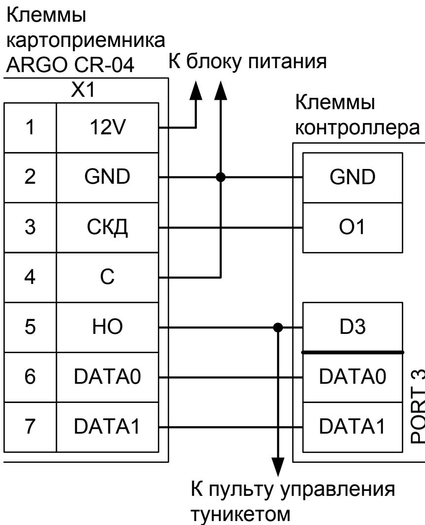
Рисунок 50. Пример подключения ARGO CR-04 в направлении «выход».
