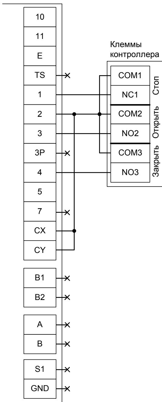
Рисунок 183. ZL92 с импульсным управлением.
