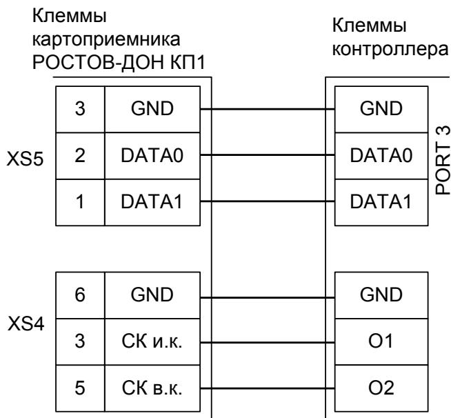
Рисунок 48. Пример подключения Ростов-Дон КП1 в направлении «выход».
