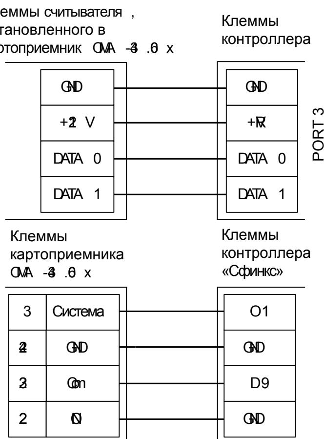
Рисунок 47. Пример подключения ОМА-43.60x на выход первой двери.
