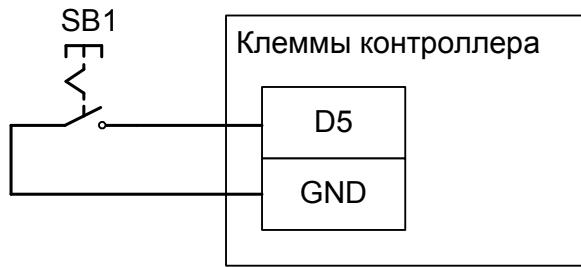
Рисунок 40. Подключение кнопки блокировки на примере первой двери.
