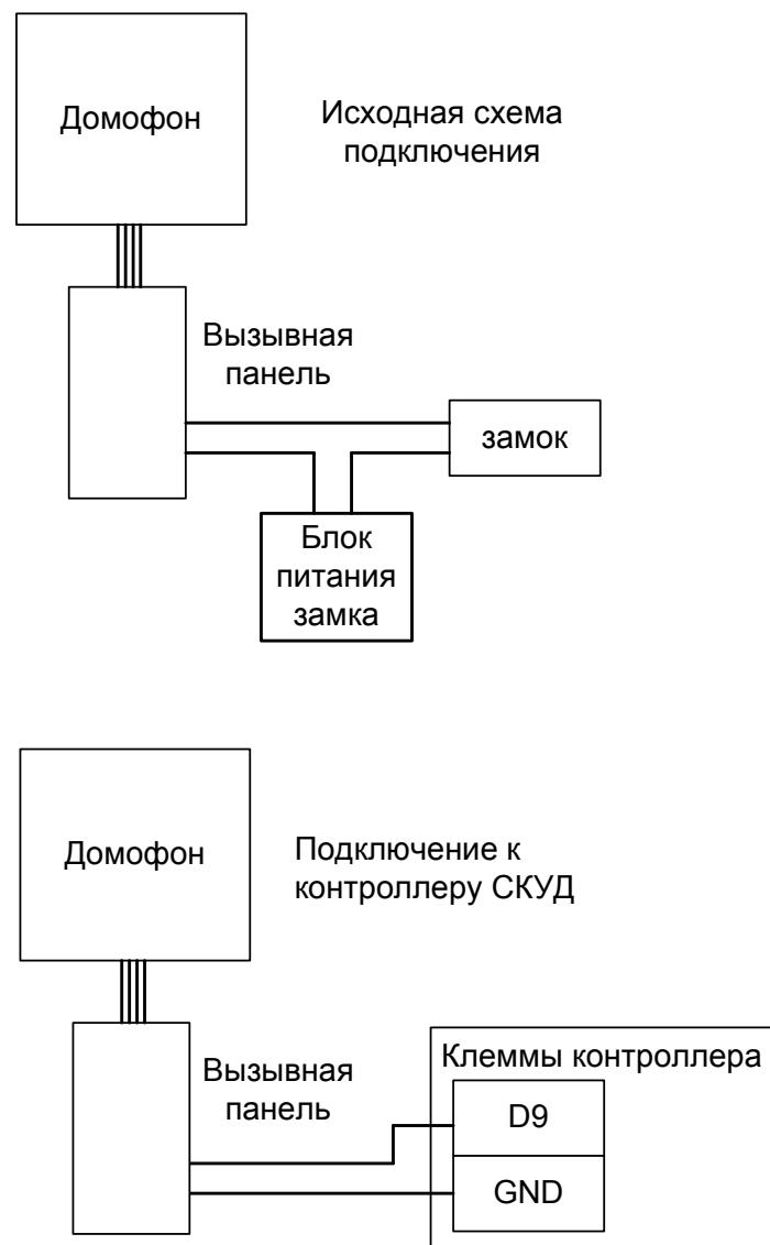
Рисунок 41. Подключение домофона с «сухим контактом» реле.
