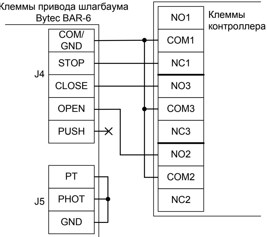
Рисунок 212. Bytec BAR-6, Skyros B-56, B-76.
