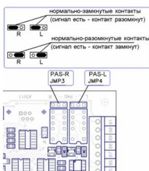
Рисунок 93. Перемычки JMP3 и JMP4 контроллера ОМА 264МС1.
