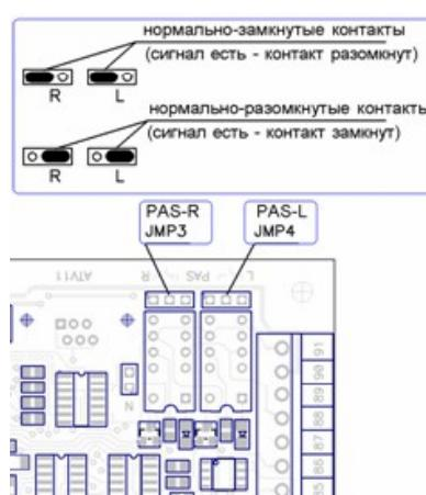
Рисунок 88. Перемычки JMP3 и JMP4 контроллера OMA-DD.958, ОМА 264MC1, 866.MC2.
