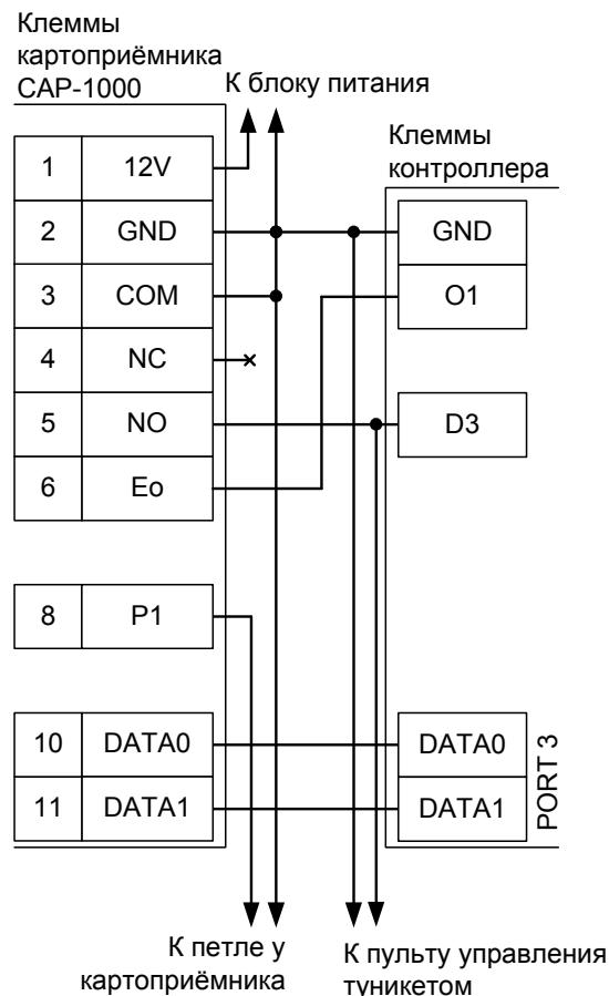
Рисунок 56. Пример подключения ParkFactor CAP-1000 в направлении «выход».
