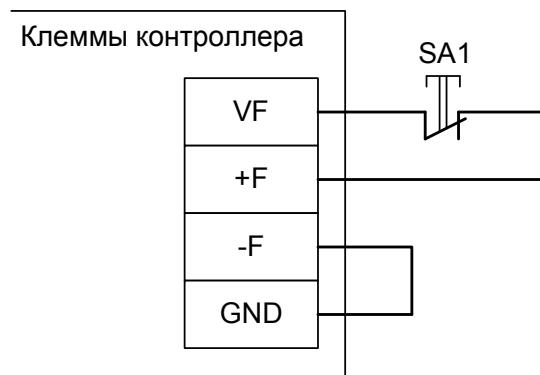
Рисунок 12. Подключение кнопки аварийной разблокировки к одному контроллеру.
