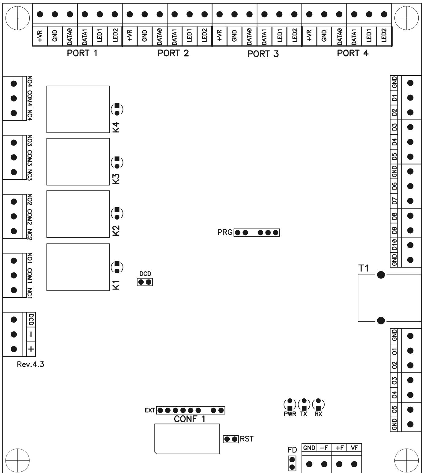
Рисунок 1. Схема расположения основных элементов на плате контроллера E500U, E900U.
