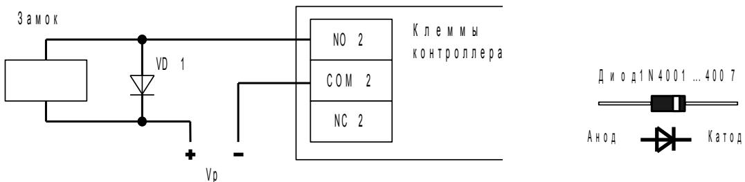
Рисунок 31. Пример подключения электромеханического замка для первой двери.
