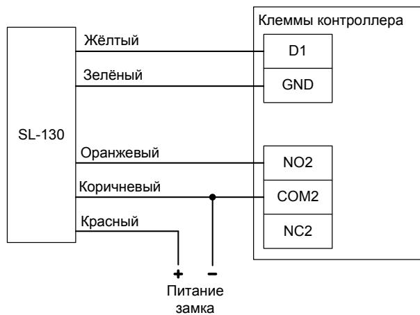
Рисунок 34. Пример подключения замка SL-130 для первой двери.
