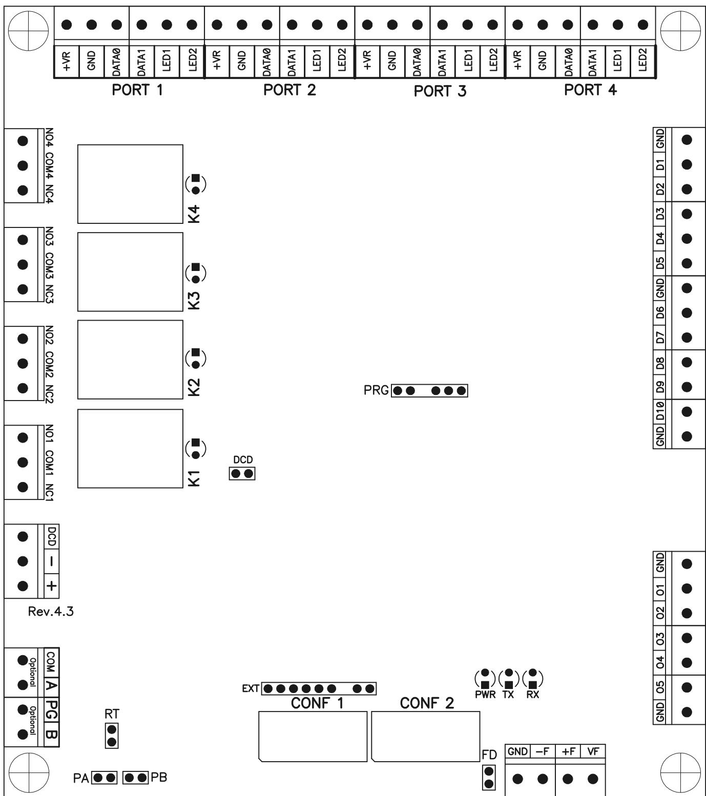
Рисунок 2. Схема расположения основных элементов на плате контроллера R500U, R900U
