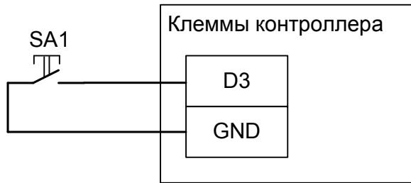
Рисунок 39. Подключение кнопки запроса прохода «выход» первой двери..
