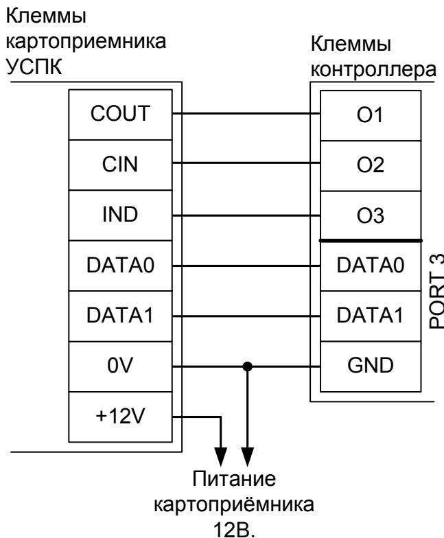
Рисунок 54. Пример подключения УСПК в направлении «выход».
