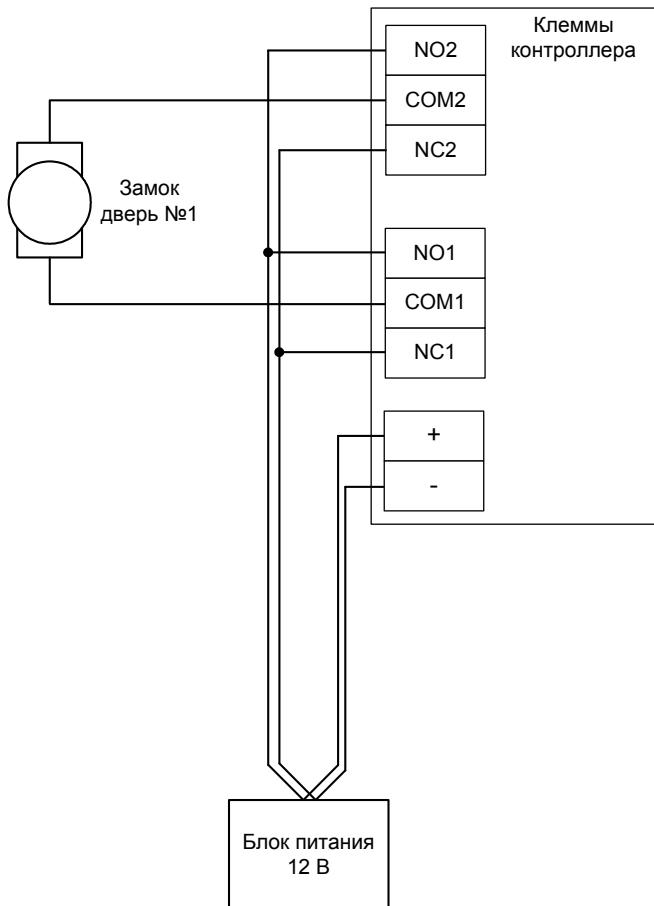
Рисунок 33. Пример подключения электромеханического замка для первой двери.
