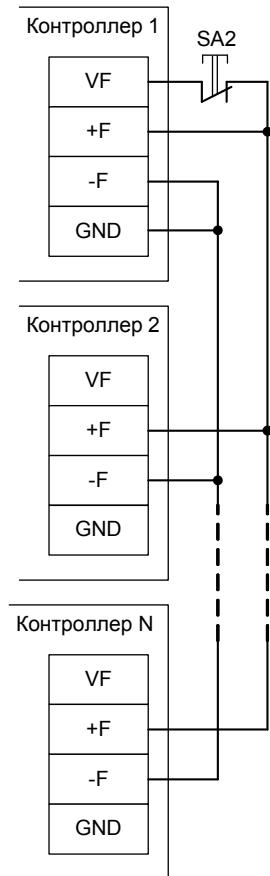
Рисунок 16. Подключение кнопки разблокирования к нескольким контроллерам.
