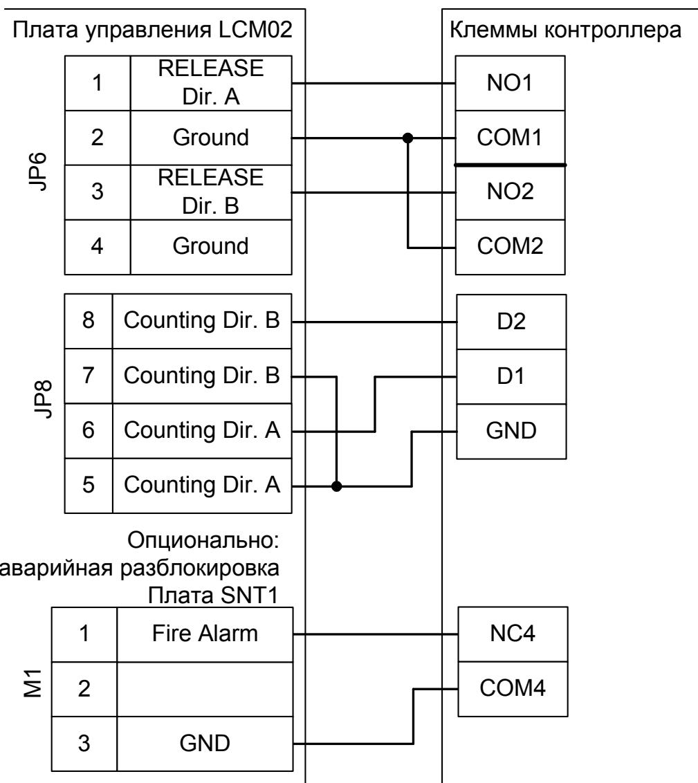
Рисунок 125. Gunnebo LCM02.
