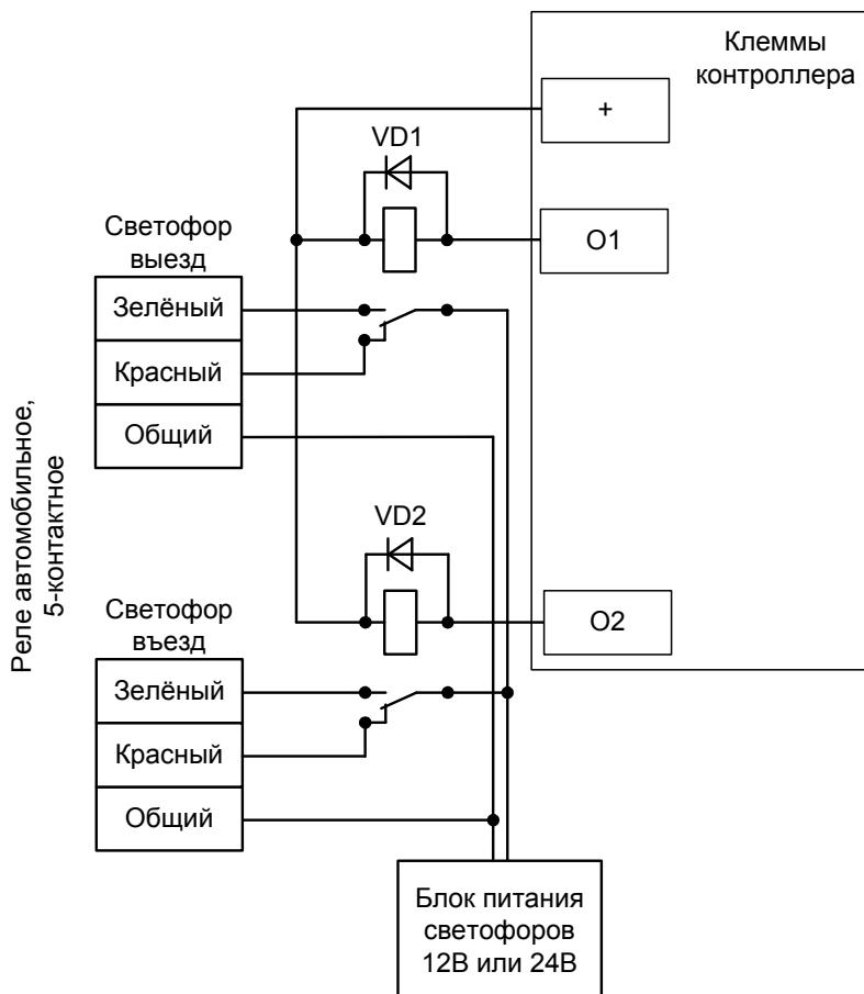
Рисунок 154. Подключение светофоров к внешним реле.
