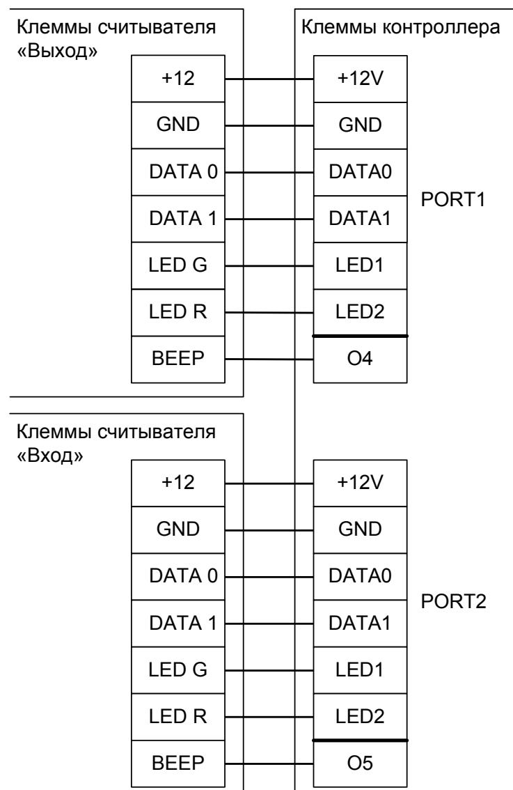
Рисунок 75. Пример подключения считывателей для PERCo-KT02 и KT05.3.
