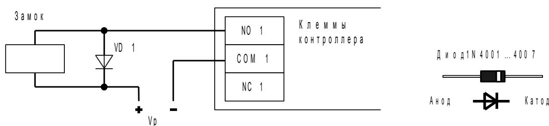
Рисунок 30. Пример подключения электромагнитного замка для первой двери.
