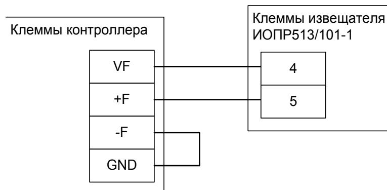
Рисунок 13. Подключение охранно-пожарного извещателя ИОПР513/101-1 к одному контроллеру.
