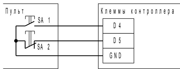
Рисунок 151. Пульт ручного управления шлагбаумом/воротами, кнопка «Стоп» нормально замкнута.
