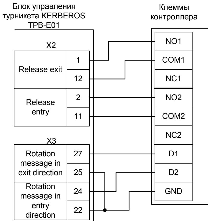
Рисунок 135. KABA Kerberos TPB-E01 с платой SINA 2.0.
