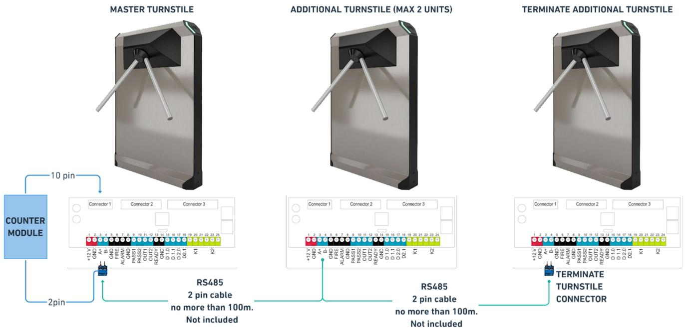
Линия связи должна представлять собой один кабель витой пары (UTP 1x2). К этому кабелю присоединяются все приемники и передатчики. Расстояние от линии до микросхем интерфейса RS-485 должно быть как можно короче, чтобы уменьшить рассогласование и отражения сигналов.
