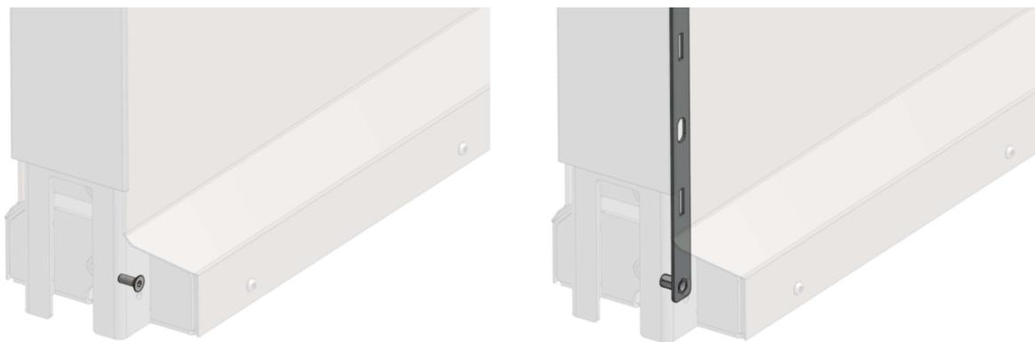
Выкрутите винты крепления Кожуха переднего. Демонтируйте Кожух передний п. 10, поддев его руками по бокам в нижней части и аккуратно вытащив верхнюю часть из-под Кожуха верхнего п. 7.
