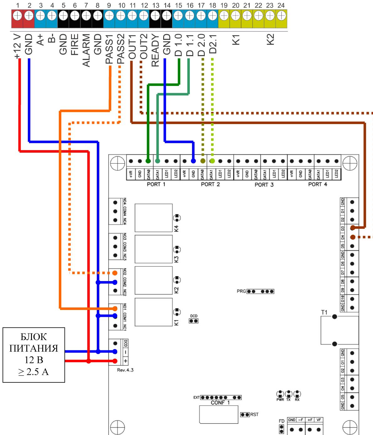
Схема подключения кнопочного пульта.
