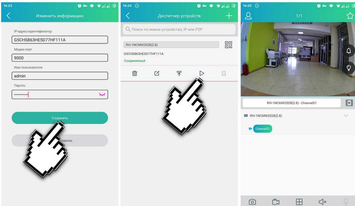
После того, как все поля были заполнены нажать кнопку «Сохранить». В следующем окне откроется окно управления устройством, где для отображения потока с камеры необходимо нажать кнопку «Воспроизведение», как это показано на скриншоте.
