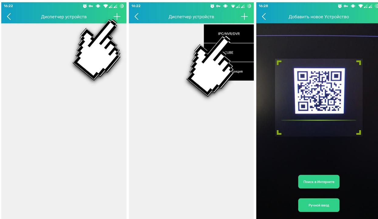
При запуске приложения откроется окно диспетчера устройств, где необходимо нажать кнопку «Добавить устройство» (плюсик сверху справа) – в контекстном меню выбрать раздел «IPC/NVR/DVR» - откроется окно со сканером QR-кода, с помощью которого необходимо отсканировать QR-код из окна информации устройства. Если такой возможности нет, то необходимо нажать кнопку «Ручной ввод» и заполнить поля идентификатора и пароля вручную.
