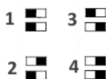
Рис. 8. Значение частотной литеры в зависимости от положения переключателей.
