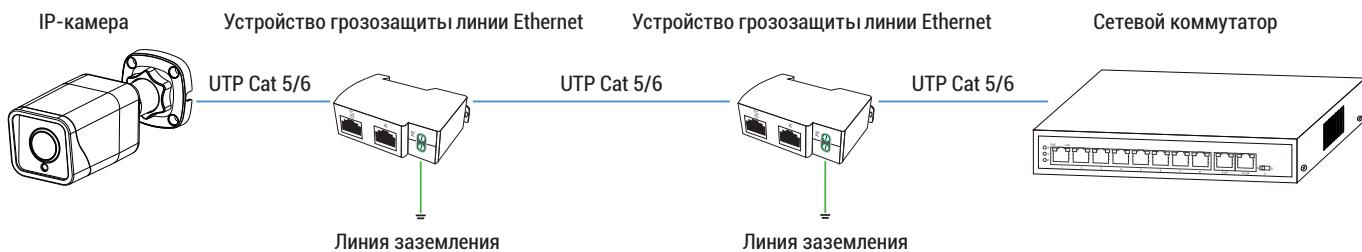
Устройство грозозащиты устанавливается с обоих концов линии, поскольку сопротивление сравнительно небольшого участка кабеля не равно нулю, и разряд может вывести из строя незащищенное активное оборудование (например, сетевой коммутатор).
