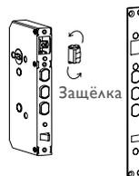
3. Установите врезную пластину и закрепите саморезами.
