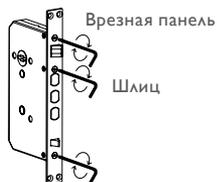
2. Выньте фиксирующий болт и поверните его на 180°, затем вставьте обратно.
