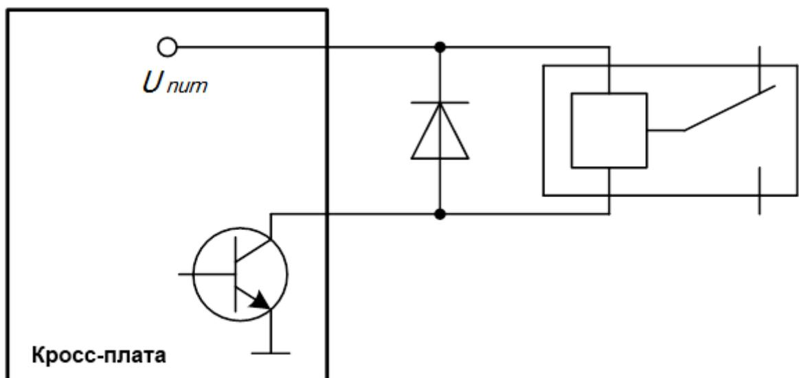
Рисунок 18 – Схема подключения диода параллельно обмотке реле
