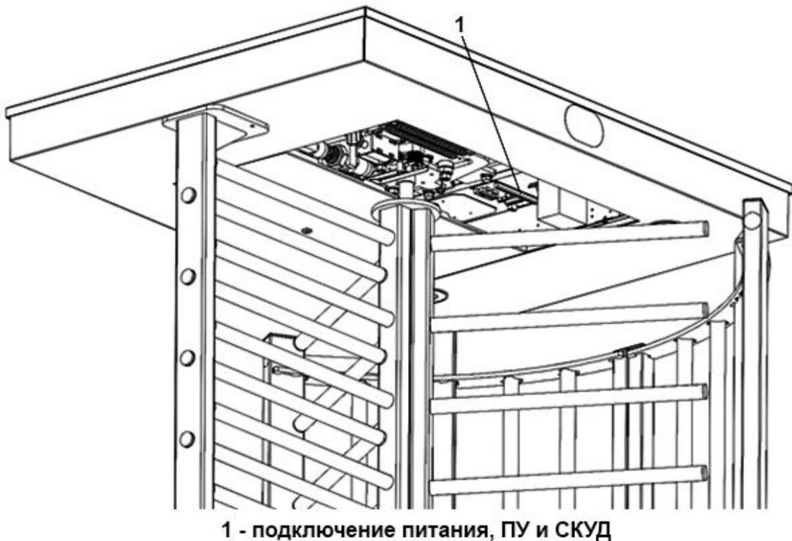
Рисунок 15 – Расположение кросс-платы на верхнем модуле турникета.
