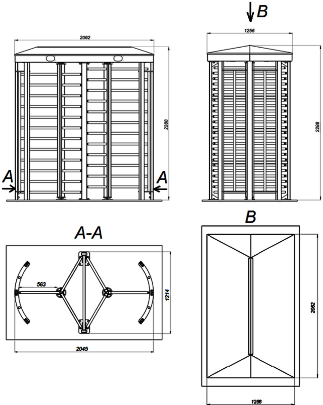
Рисунок 22 – Габаритные размеры модификаций турникетов Double pass
