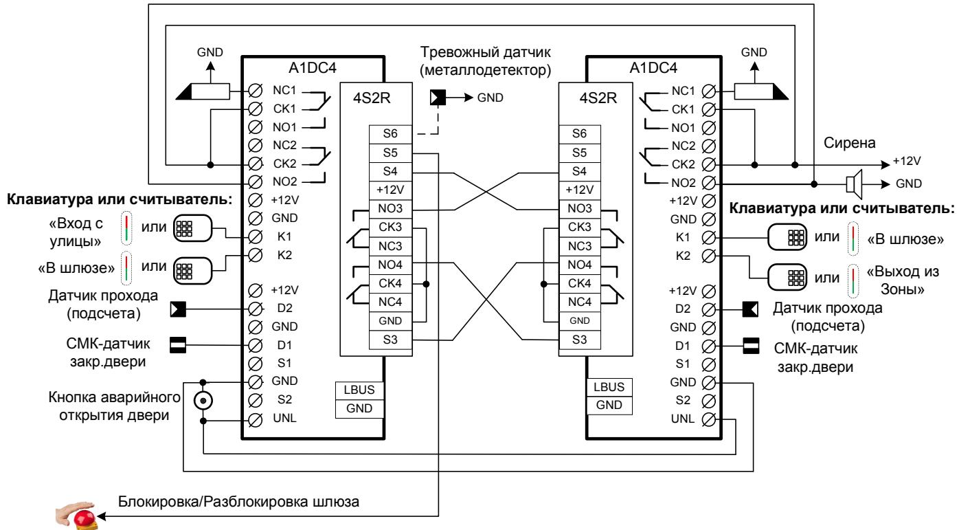
Система управления шлюзом на двух контроллерах с взаимными блокировками по контактам реле R3-R4 на S4-S3 на модулях расширения 4S2R. Блокировка по кнопке на S5 и по датчику на S6.
