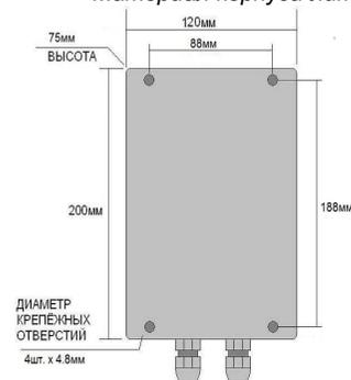
Гермовводы под сетевой кабель наружного диаметра мах Ø10мм
