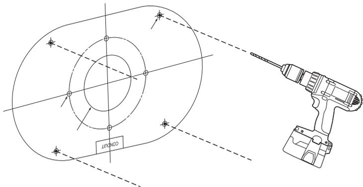
**2-2.** Удалите заглушку отверстия трубы с монтажной панели, надавив на нее по бокам.
