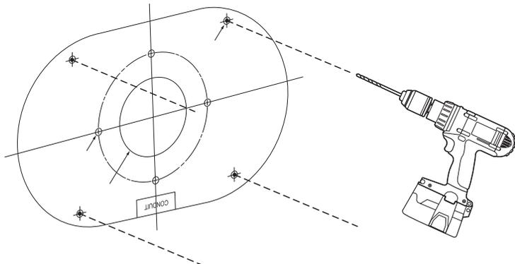
1-2. Закрепите монтажную панель с помощью подходящих винтов.
