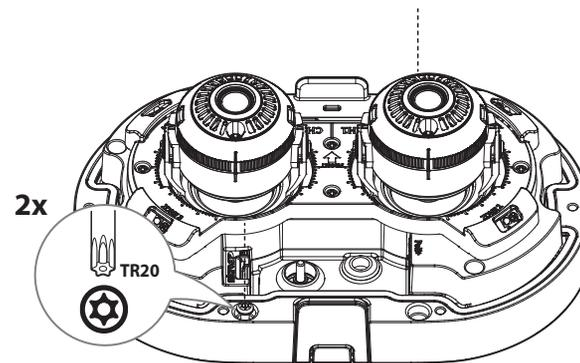
3. Снимите корпус камеры с монтажной панели.
