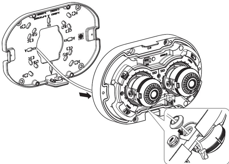
2-4. Подключите разъем сетевого кабеля к порту PoE+ на корпусе камеры.
