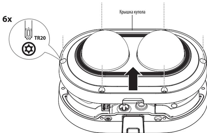
2. Отверните крепежный винт на корпусе камеры.
