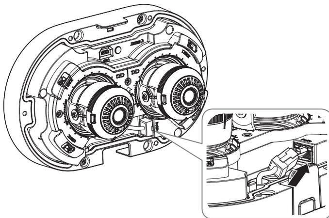
3. Используя крепежные винты на корпусе камеры, закрепите его на монтажной панели.
