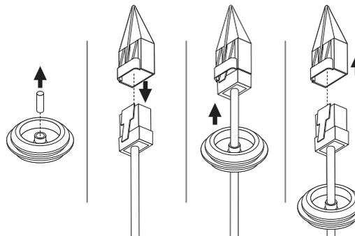
2-3. Закрепите кабельный ввод на корпусе камеры.
