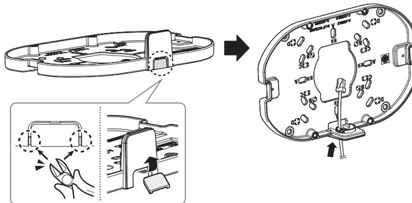
1-3. Протяните кабель локальной сети через отверстие в монтажной панели.
