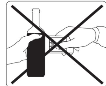
2.2.7. В случае некорректного приложения контактной площадки прибора к стенке емкости или недопустимой неоднородности стенки сосуда загорается мерцающий желтый индикатор.
