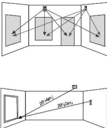
Рис. 2. Установка извещателя
