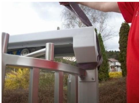
Шаг 5: При снятии турникета с паллеты убедитесь в безопасности крепления к подъемному механизму, для предотвращения падения турникета.
