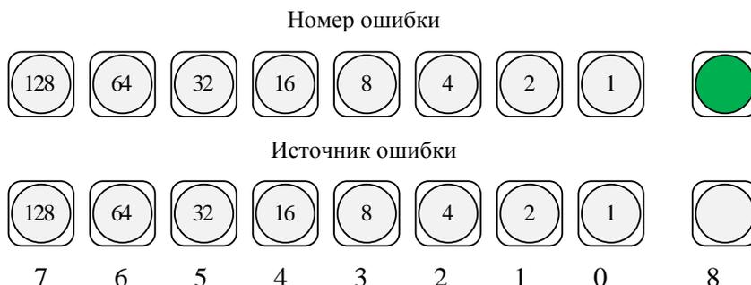
Рис. 34- Индикация номера ошибки и источника ошибки
