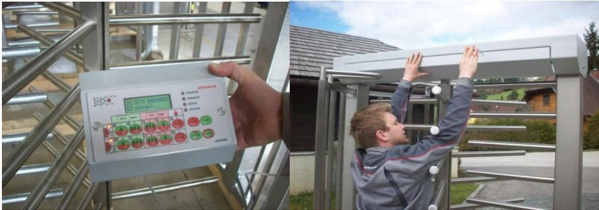
Шаг 16: Выполните проверку функционирования с помощью панели управления. Значения параметров могут быть адаптированы к условиям. Проверьте направление запираения в режиме отключения питания и при необходимости измените в соответствии с описанием в следующей главе. Установите направление входа и выхода в соответствии с требованиями на месте установки с помощью DIP-переключателя 6. Подключите устройства чтения карт и других устройств. Затем установите защитный кожух.
