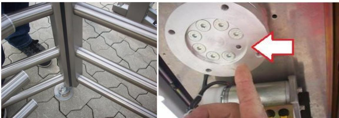
Шаг 13: Установите вращающийся барабан на опорный штифт и поверните таким образом, чтобы отверстие (стрелка) находилось на одном уровне с рядом рычагов. На дисках с механизмом блокировки проверьте направление запираения и при необходимости отрегулируйте.
