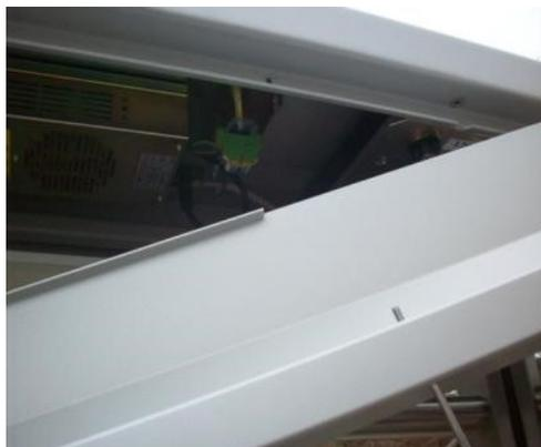
Шаг 2: Снимите защитный кожух используя шестигранник 4 мм. Проядите за тем, чтобы винты не потерялись после снятия защитного кожуха.
